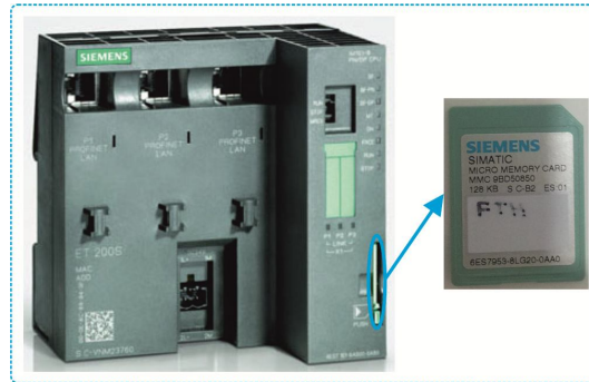
Şekil 4.4. IM 151-8 PN/DP CPU ve micro memory kart gerçek görüntüsü
