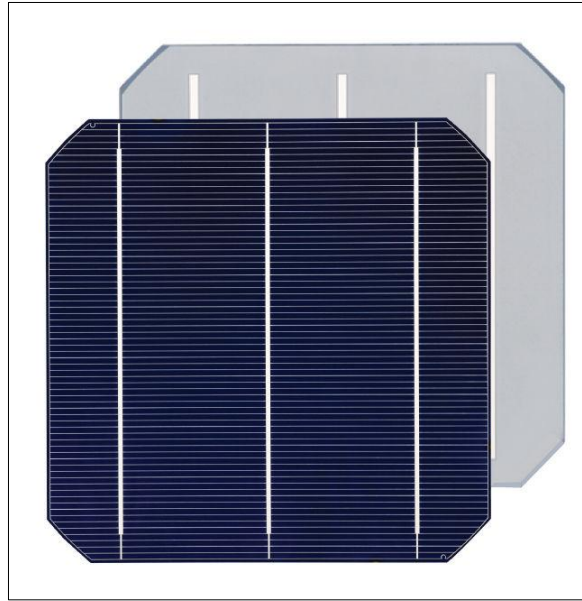
Şekil 2.3. Tek kristal hücreler ile oluşturulan güneş pili.
