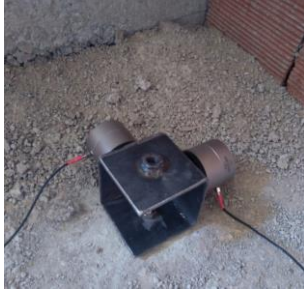
Şekil 7. Levha yardımıyla yapıya tutturulan KB12VD tipi ivmeölçerler
