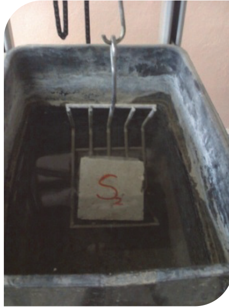
Resim 4.1. Sertleşmiş Betonun Yoğunluğunun Tayini Numunesi
