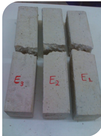
Resim 4.4. Eğilme Deneyi Sonucu Oluşan Kırılma
