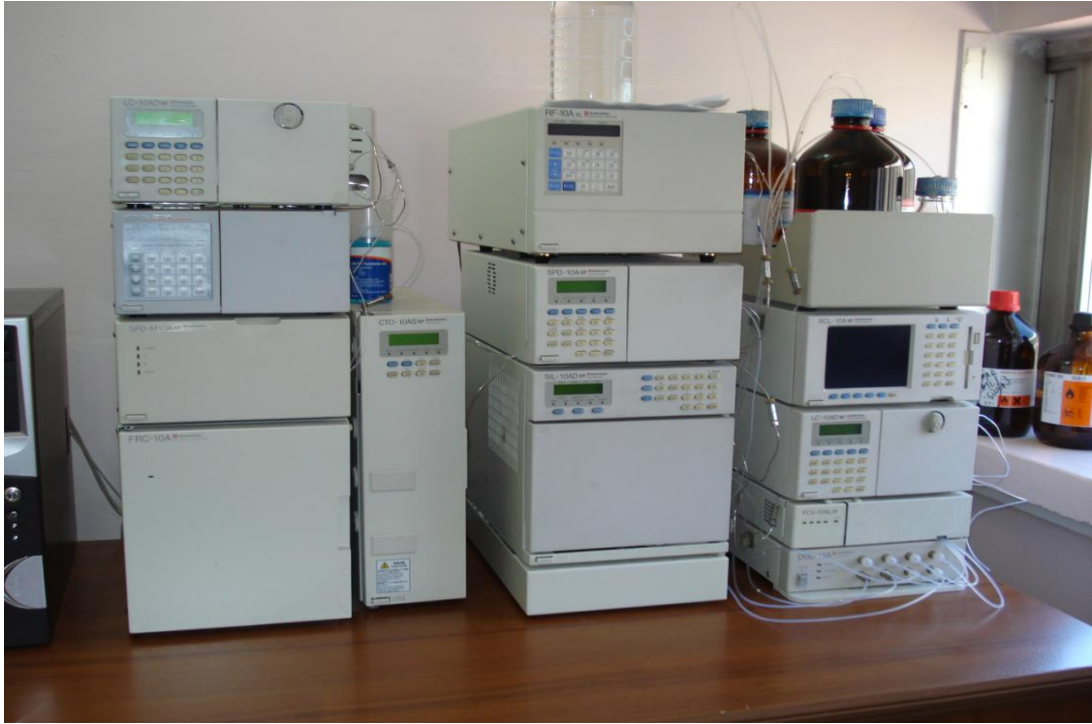
Şekil 2.4. CECİL 1100 model yüksek performanslı sıvı kromatografi cihazı
