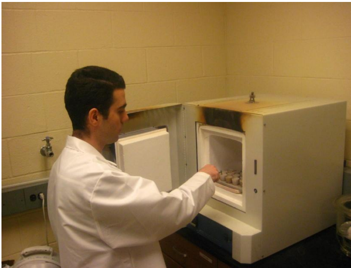
Şekil 2.20. Seramik kaptaki sepiyolit numunelerinin 200°C'deki fırına konulması
