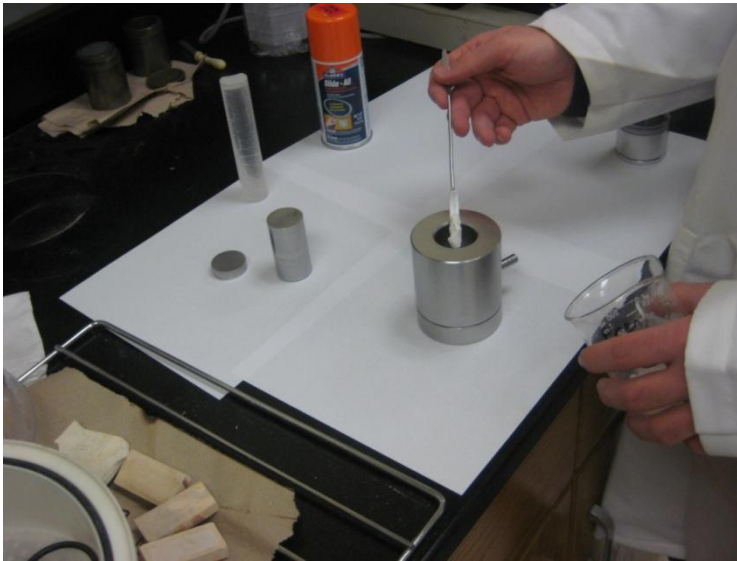
Şekil 2.13. Metal kaşık ile tüpün içerisine sepiyolit konulması
