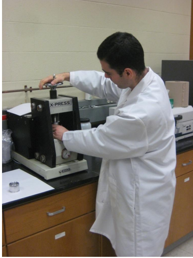
Şekil 2.15. Alüminyum parçaların basınçlı sıkıştırıcı makinesinin içerisinden çıkarılması
