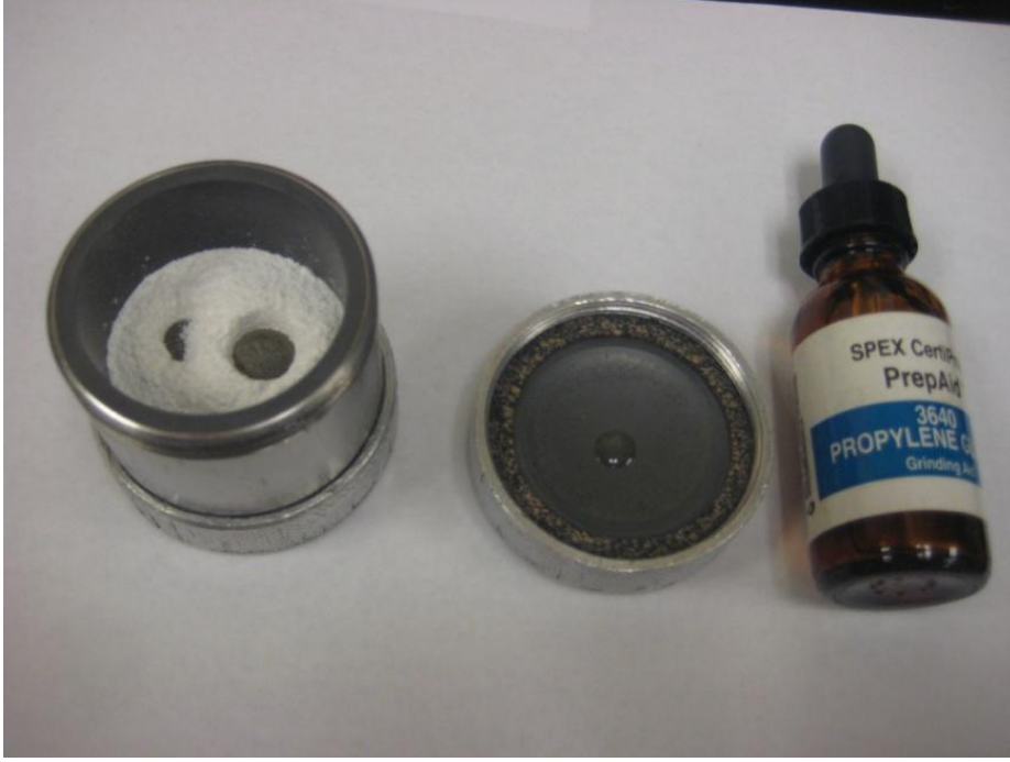
Şekil 2.5. Sepiyolit numunesinin toz haline getirildiği tungstenkarbid kapsül
