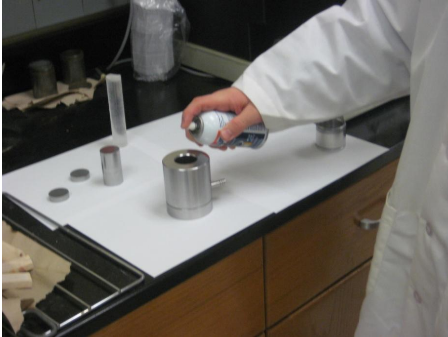
Şekil 2.11. Tüpün içerisine yüzeysel sürtünmeyi azaltıcı spreyn sıkılması
