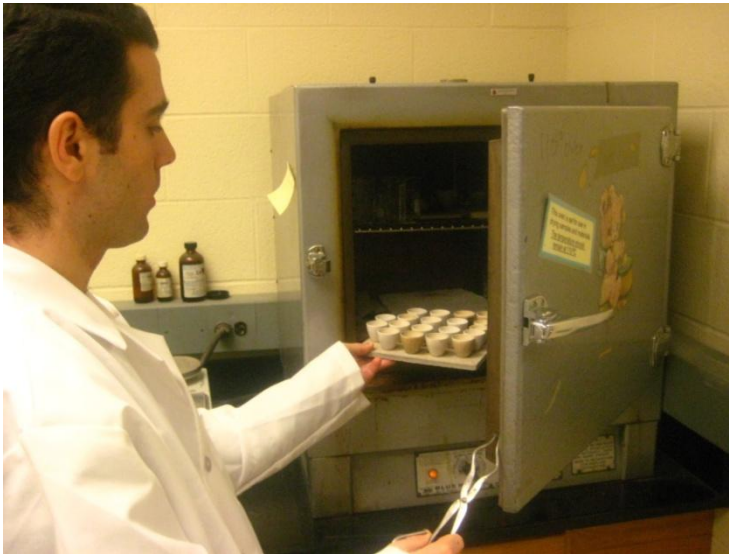
Şekil 2.18. 110 °C sıcaklıktaki fırından seramik kapların metal kısıka ile alınması
