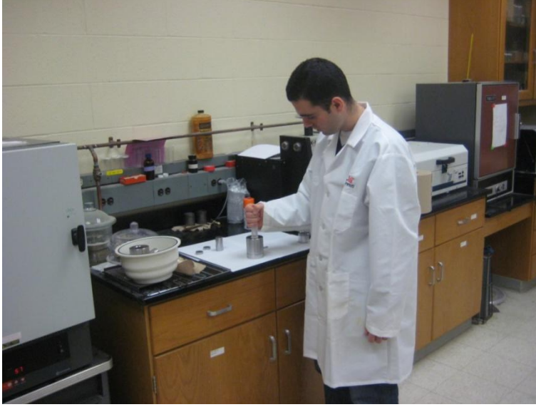
Şekil 2.12. Cam tokmak ile alüminyum kabın tüpün tabanına yerleştirilmesi
