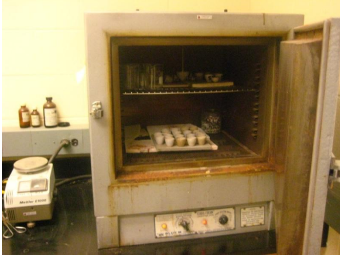
Şekil 2.21. Seramik kaptaki sepiyolit numunelerinin 110^{\circ}\text{C} 'deki fırında soğuması
