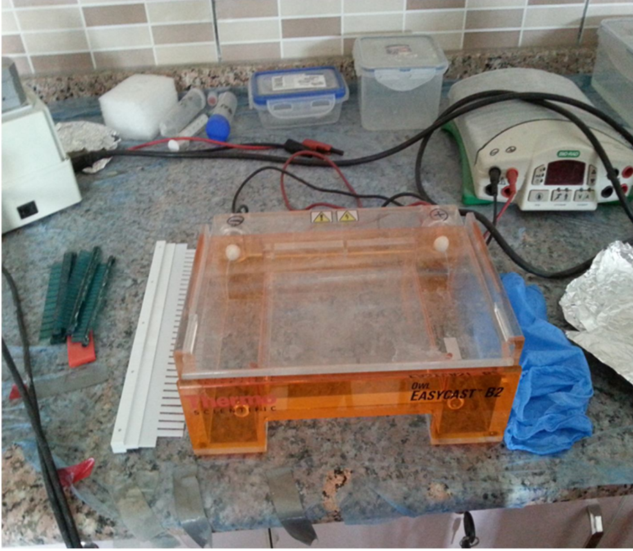
Şekil 4.5. Thermo marka agaroz jel elektroforezinde DNA kontrolü
