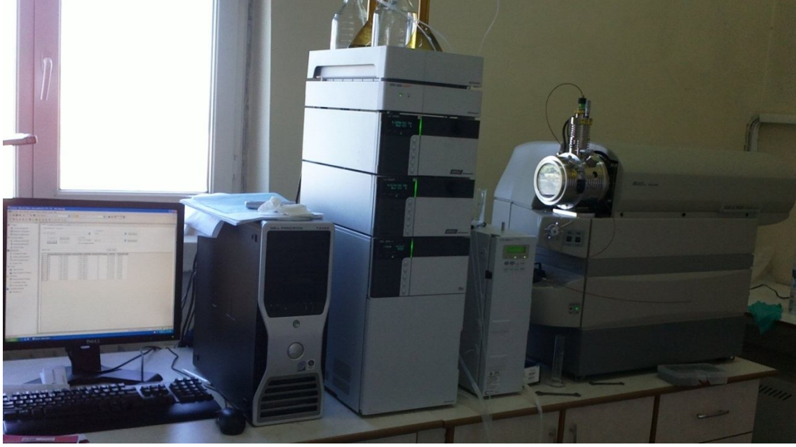
Şekil 4.3. CTC ve parçalanma ürünleri analizinde kullanılan LC-MS/MS cihazı
