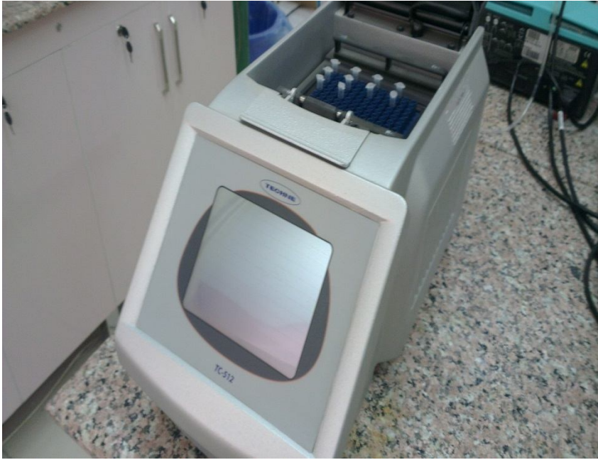
Şekil 4.4. PCR işleminde kullanılan TECHNE /TC-512 marka cihazın görünümü
