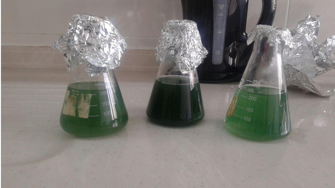
Şekil 3.2. Soldaki kültür mavi led ışık, ortadaki kültür kırmızı led ışık, sağdaki kültür ise gün ışığı led ışık aydınlatması ile aydınlatılan ortamların deney sonu fotoğrafları (15 mg/L \text{Na}_2\text{SeO}_3 'li ortamlar)
