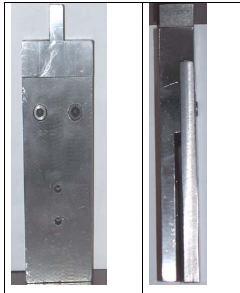
Şekil 6.4. Deney numunelerini çekme cihazına bağlayan ara parçanın resmi.
