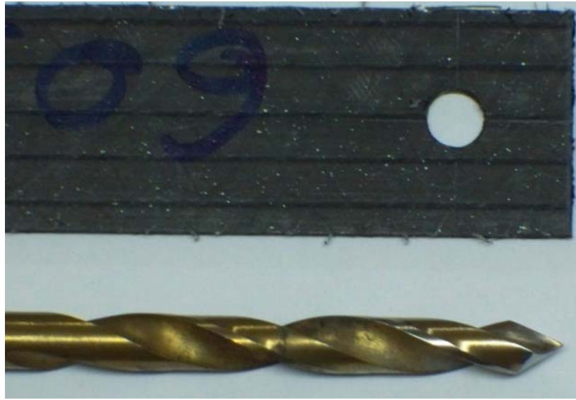
Şekil 6.2. Matkap ucu ve plaka üzerine açılmış delik.
