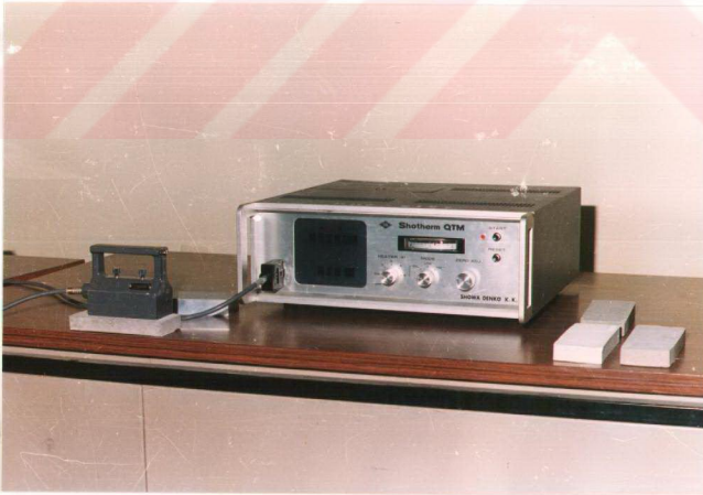
Şekil 5.2. Isı İletim Katsayısı Ölçme Aleti
