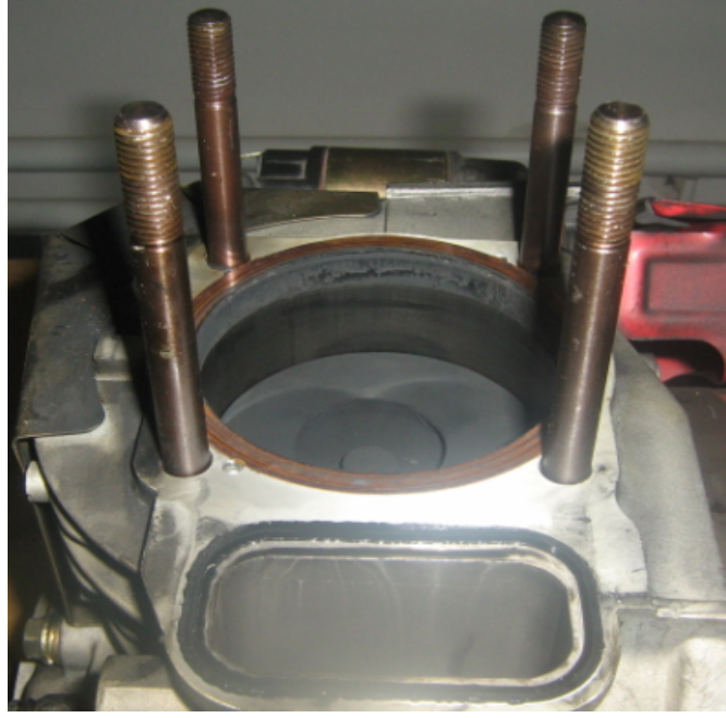
Şekil 5.30 B20 ile çalışma sonunda piston ve silindirin üst kısmının görünümü.
