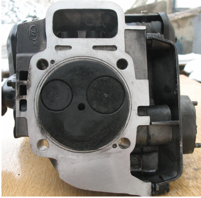
Şekil 5.24 Dizel yakıtı ile çalışma sonunda üst kapağın görünümü.
