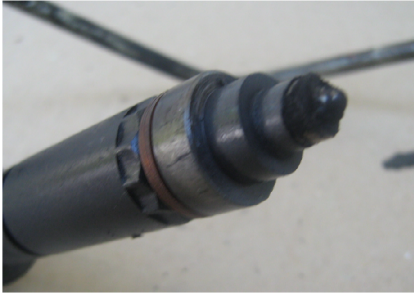
Şekil 5.36 B20 ile çalışma sonunda yakıt enjektörünün genel görünümü.
