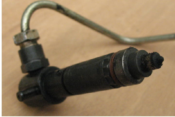
Şekil 5.26 Dizel yakıtı ile çalışma sonunda yakıt enjektörünün genel görünümü.
