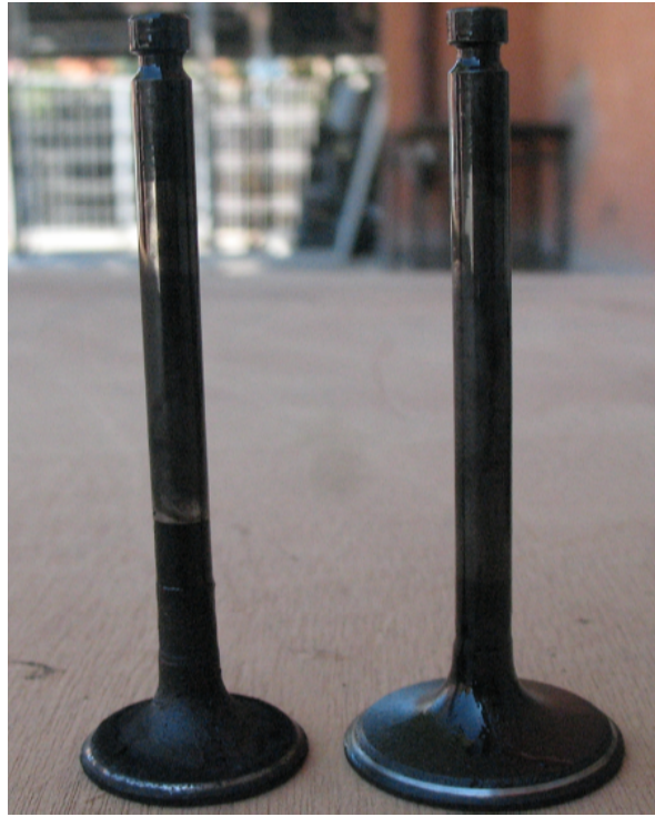
Şekil 5.25 Dizel yakıtı ile çalışma sonunda emme ve egzoz supaplarının genel görünümü.
