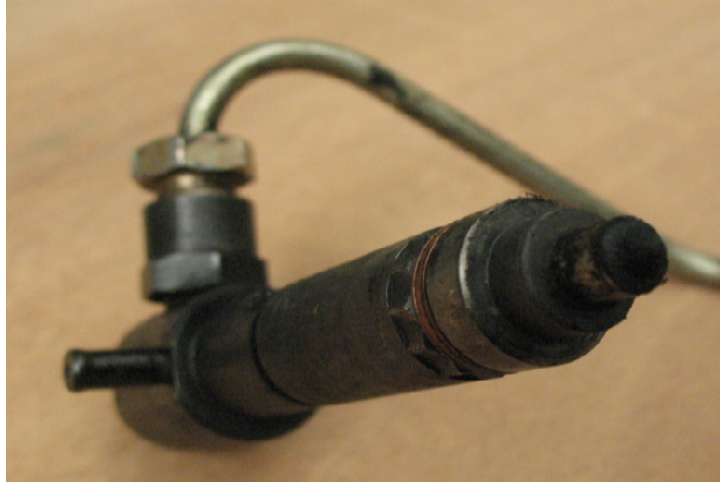
Şekil 5.27 Dizel yakıtı ile çalışma sonunda enjektör ucunda oluşan birikintinin görünümü.
