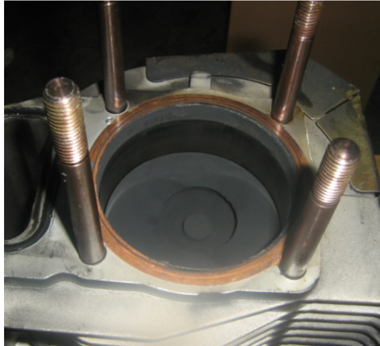
Şekil 5.29 B20 ile çalışmada pistonun üst kısmı ve silindir cidarlarının görünümü.
