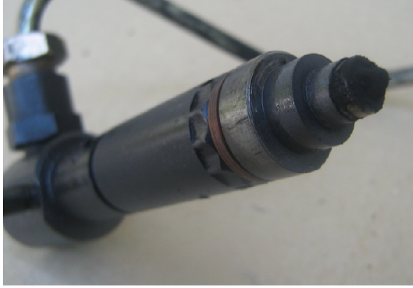
Şekil 5.35 B20 ile çalışma sonunda enjektör ucunda oluşan birikintinin görünümü.
