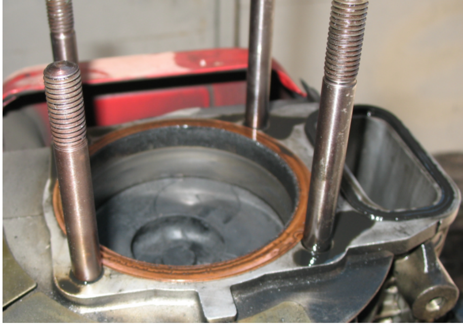
Şekil 5.22 Dizel yakıtı ile çalışma sonunda yanma odası ve silindir cidarlarının görünümü.
