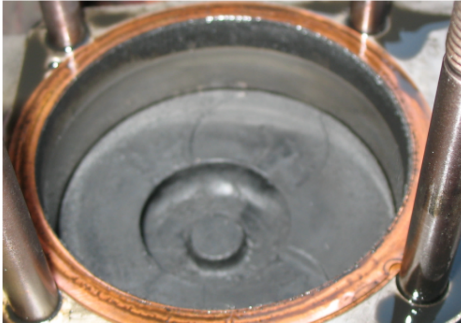
Şekil 5.23 Dizel yakıtı ile çalışma sonunda silindirin üst kısmının görünümü.
