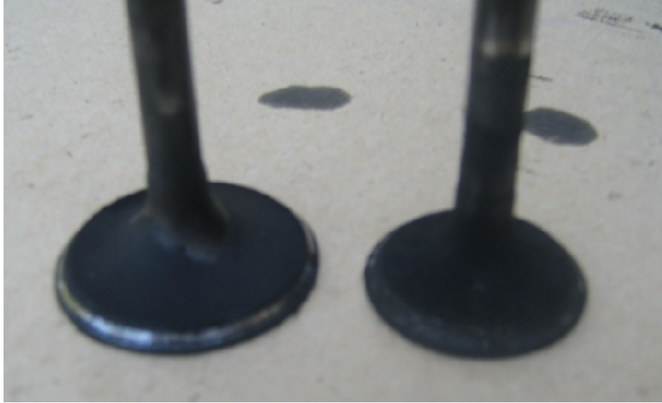
Şekil 5.34 B20 ile çalışma sonunda emme ve egzoz supaplarında oluşan birikintiler.
