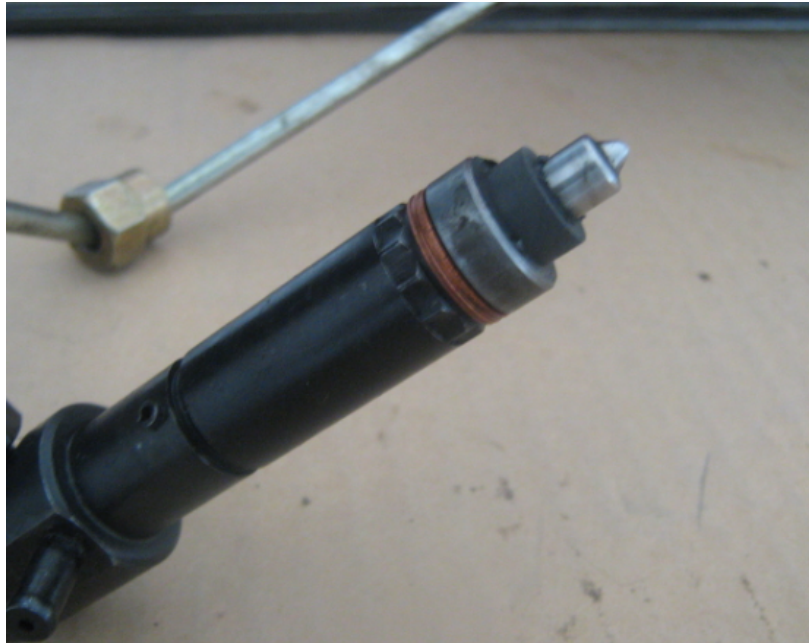
Şekil 5.19 Deneyler yapılmadan önce yakıt enjektörünün genel görünüşü.
