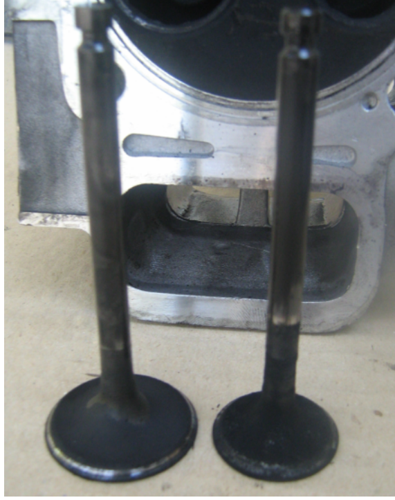
Şekil 5.33 B20 ile çalışma sonunda emme ve egzoz supaplarının genel görünümü.
