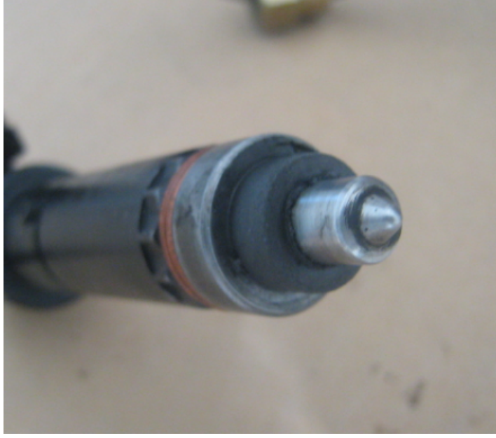
Şekil 5.20 Deneyler yapılmadan önce enjektör ucunun genel görünüşü.
