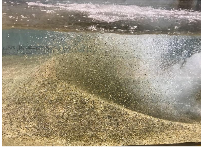
Şekil 4.14 Deneyin başlatılması ile oyulmanın başlaması
