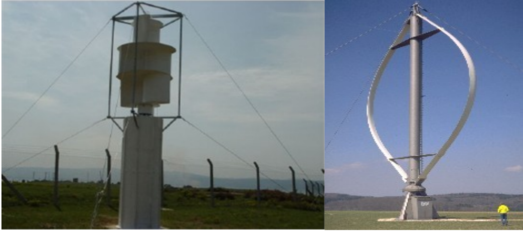
Şekil 2. 4. Savonius ve Darrieus düşey eksenli rüzgar türbinleri
