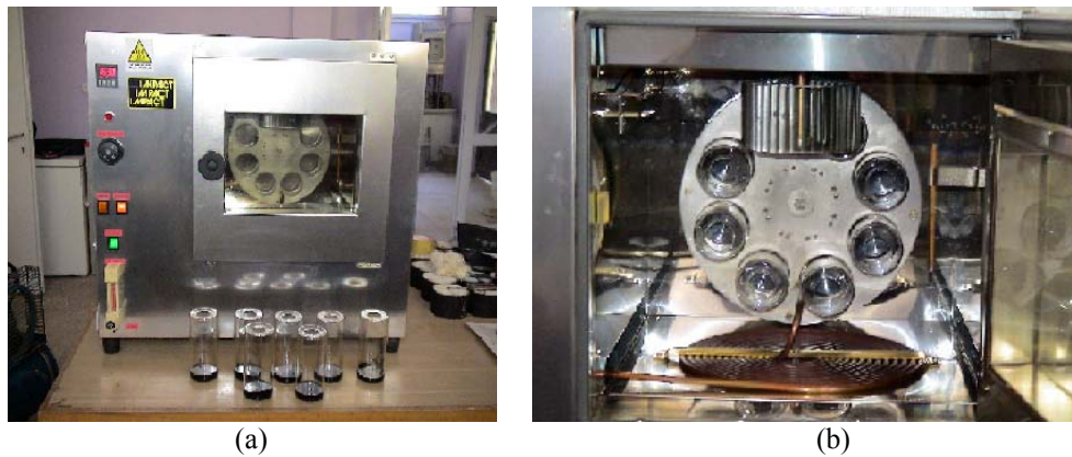
Şekil 5.4. Dönel İnce Film Etüvü (RTFOT) Aleti (a) ve Şişelerin Yerleştirilmesi (b)
