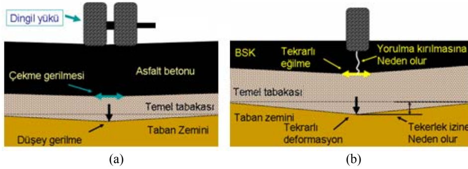
Şekil 2.17. Tipik Bir Esnek Üstyapısı (a) ve Oluşan Bozulmalar (b) [45]
