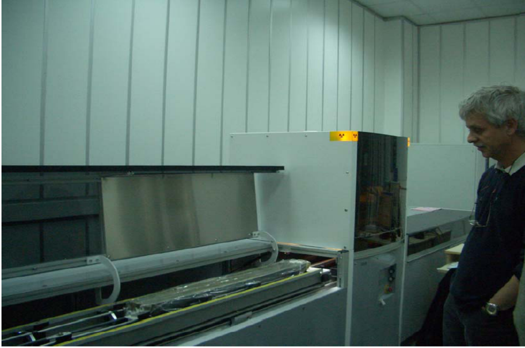
Şekil 3.1. ITRAX Karot tarayıcısı
