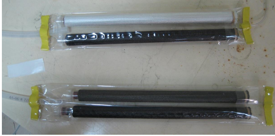
Şekil 4. 24. Vakumlanmış ortamda reçine beslemesi öncesi şaft numuneleri
