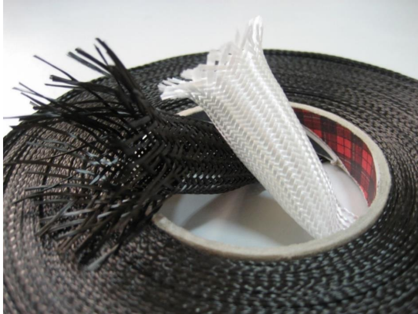
Şekil 4. 13. Şaft üretiminde kullanılan cam ve karbon lifler
