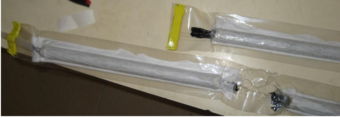
Şekil 4. 17. Vakum torbasına sarılarak vakum altına alınmış numuneler
