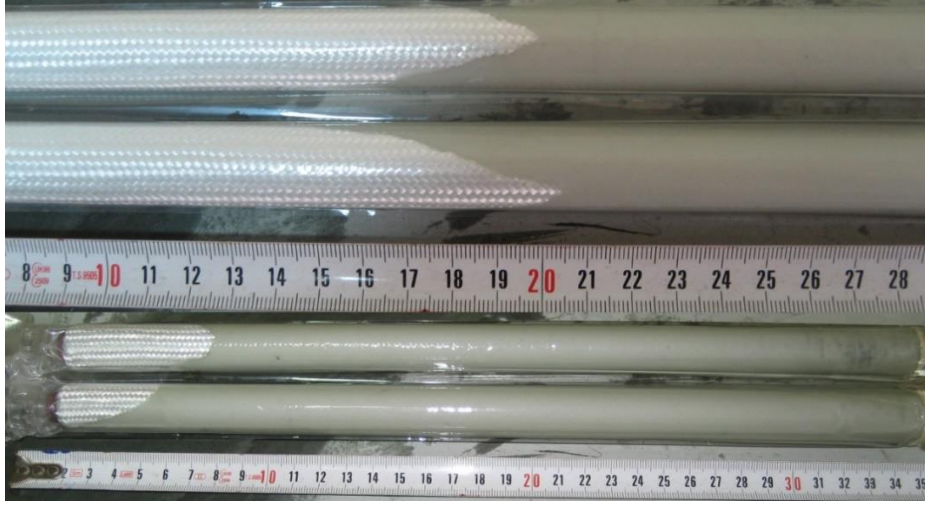
Şekil 4. 28. Vakum altındaki numunelerde reçinenin ilerlemesi
