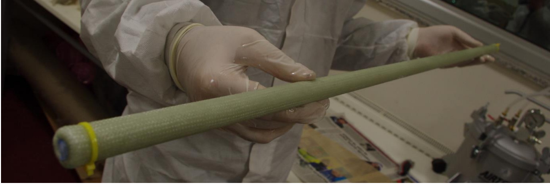
Şekil 4. 14. Vakum torbalama yöntemi ile üretilen şaft numunesi
