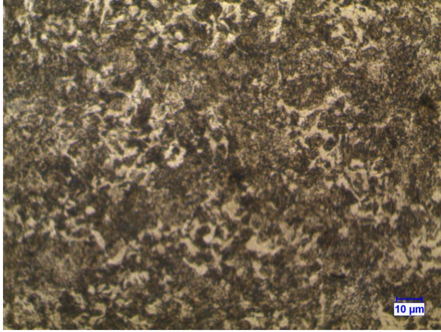
Şekil 2. 61. h2 kodlu ısıt işlem uygulanan şaftın çekirdek bölgesine ait mikroyapısı
