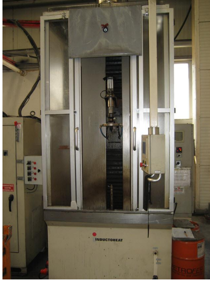
Şekil 2. 33. İndüksiyon ile yüzey sertleştirme cihazı
