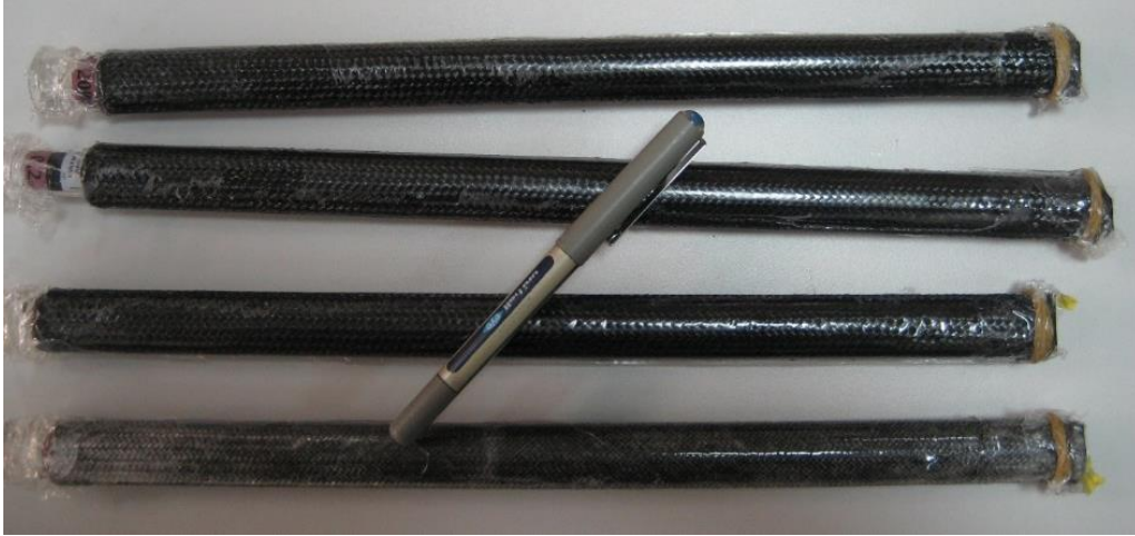
Şekil 4. 32. VARTM ile üretilmiş numunelerin ham hali
