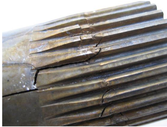
Şekil 3. 16. Milin diş diplerinde meydana gelen yüksek gerilmeler sonucu çatlak oluşumu
