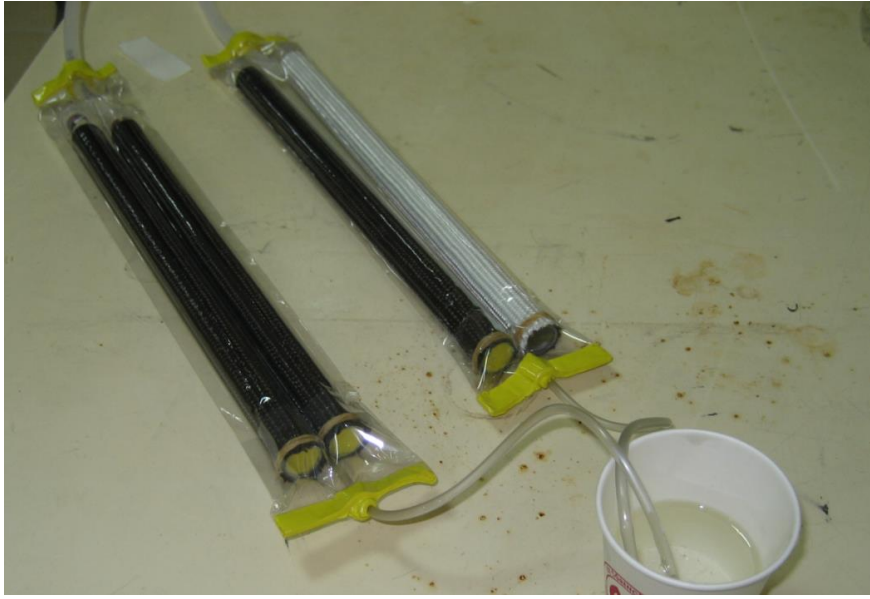
Şekil 4. 26. Vakum altındaki numunelere reçine beslemesinin yapılması
