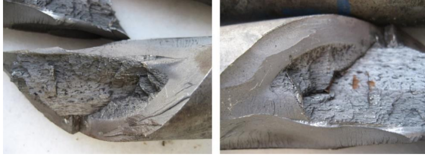
Şekil 3. 29. Millerin kırık yüzey görüntüsü
