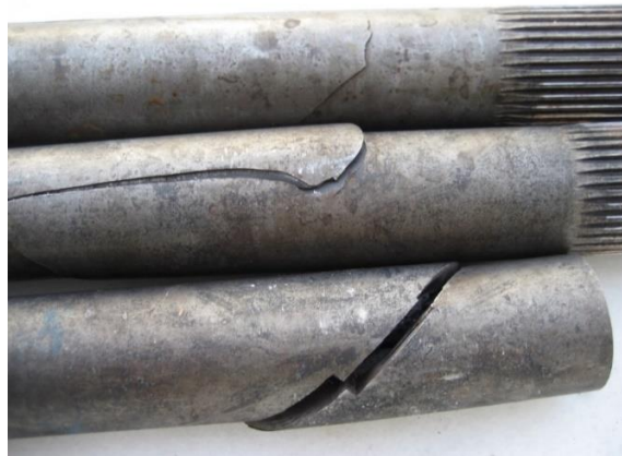
Şekil 3. 28. Dişsiz bölgeden hasara uğramış mil numuneleri
