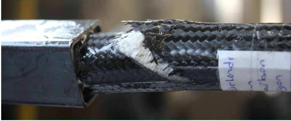
Şekil 4. 38. Burulma sonucu hasara uğramış hibrit/Al kompozit şaft numunesi
