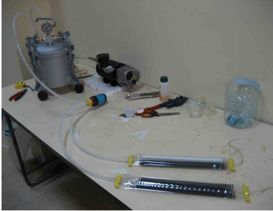
Şekil 4. 25. Vakumlanmış ortamda reçine beslemesi öncesi şaft numuneleri
