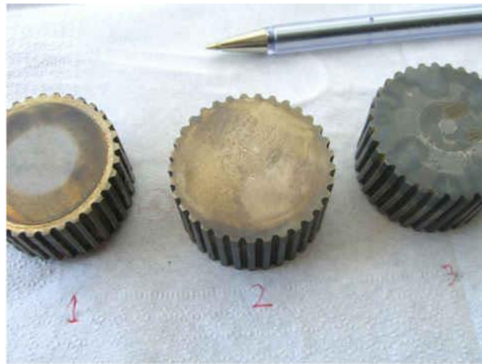
Şekil 3. 25. 1, 2 ve 3 numaralı numunelerin hasarlı bölgesindeki kırık görüntüsü
