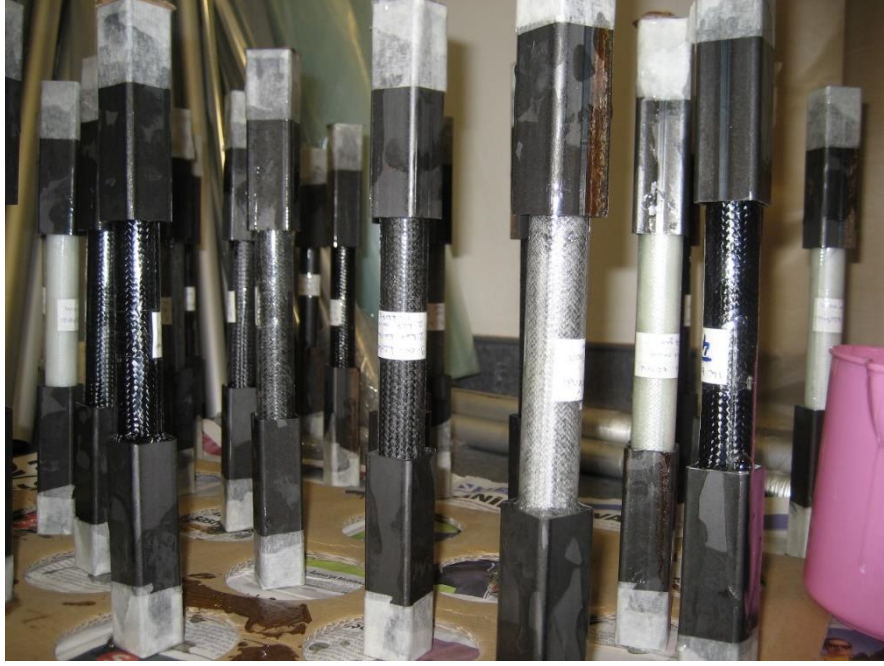
Şekil 4. 34. Tutucu uçların yapıştırıldığı, deneye hazır numuneler
