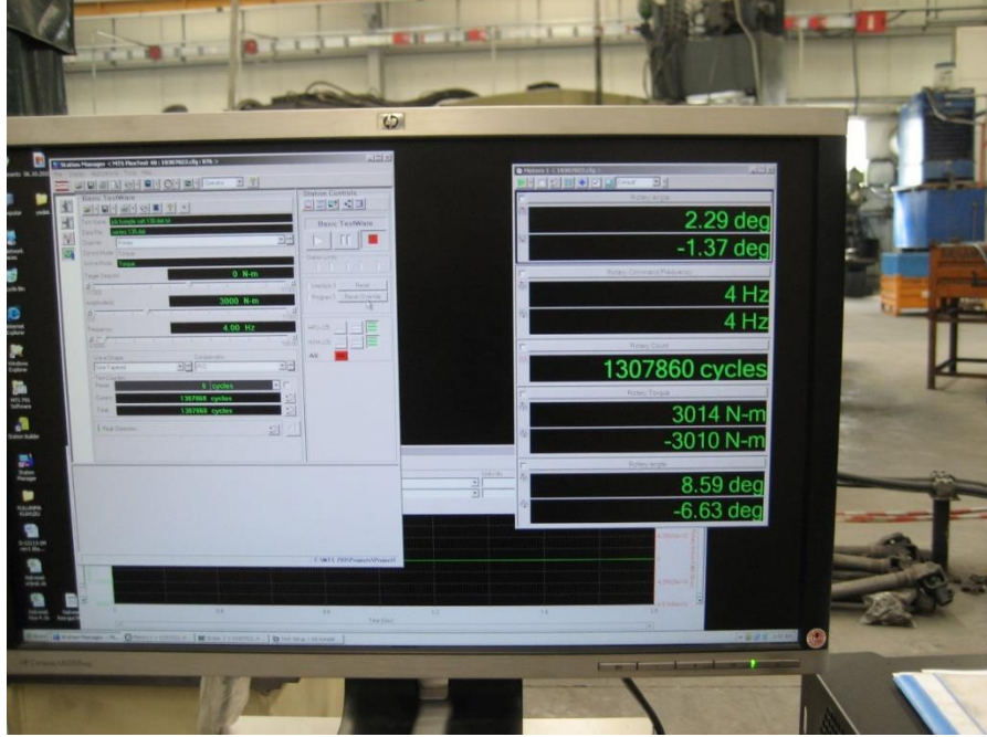
Şekil 2. 35. Yorulma test cihazı kontrol ekranı
