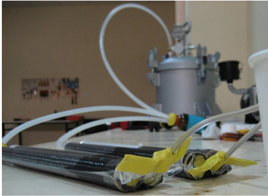
Şekil 4. 27. Vakum altındaki numunelere reçine beslemesinin yapılması
