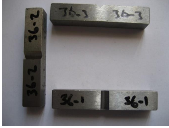
Şekil 2. 29. ASTM E 23-02A standardına göre hazırlanan çentik darbe numuneleri
