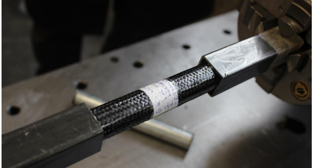
Şekil 4. 37. Burulma makinesine bağlanmış hibrit/Al kompozit şaft numunesi
