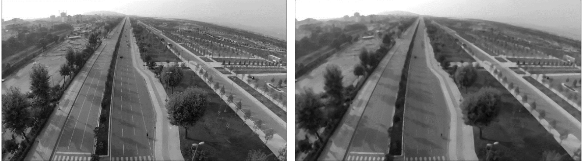
Şekil 2.17. Gri görüntü ve Mean filtre uygulanmış görüntü.
