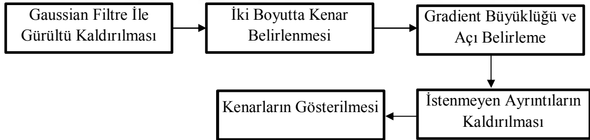
Şekil 2.19. Canny kenar kaldırma algoritmasının adımları.
