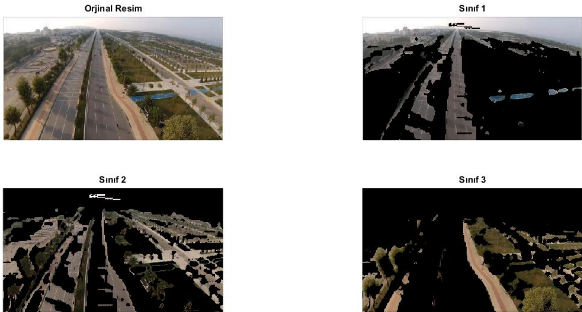
Şekil 2. 25. K-Means ile sınıflandırılmış görüntü.
