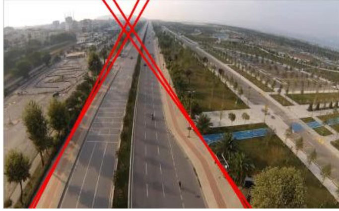
Şekil 3.13. Hough dönüşümü ile tespit edilen yol görüntüsü.
