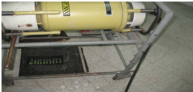
Şekil 8.14.Film, penetremeter, şablonlu kalıp, ışın kümesi [84].
