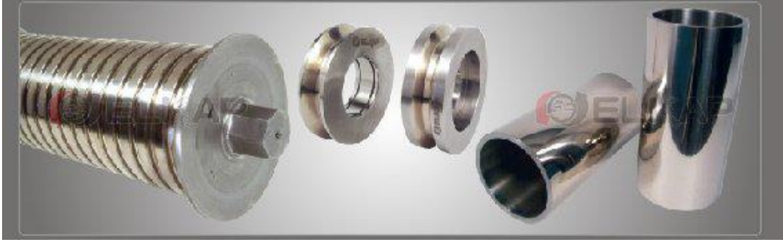
Şekil 3.8. Alev püskürtme ile yüzey kaplanmış numuneler
