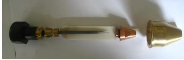
Şekil 5.7. Elektrod bağlantısının şematik görünümü
