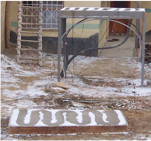
Şekil 3.27 Karın nasıl eritildiğinin aşama aşama görünümü
