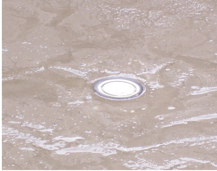
Şekil 3.17 Sensörün köprü bloğu içine yerleştirilişi
