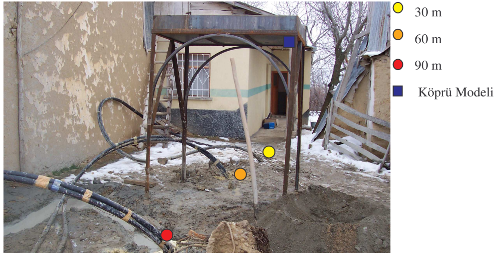
Şekil 3.6 30, 60 ve 90 m derinliğindeki kuyular ile köprü modelinin birlikte görünümü
