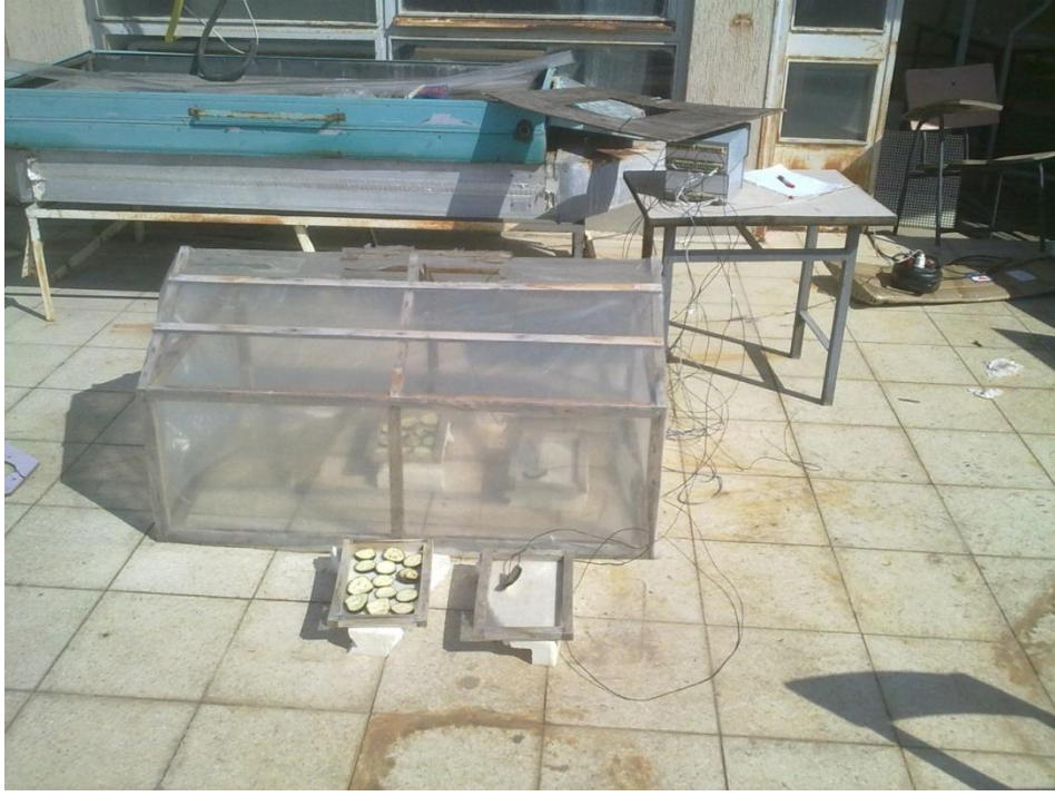
Şekil 5.4. Doğal taşınımında sera ve güneş altında kurutulan örnekler
