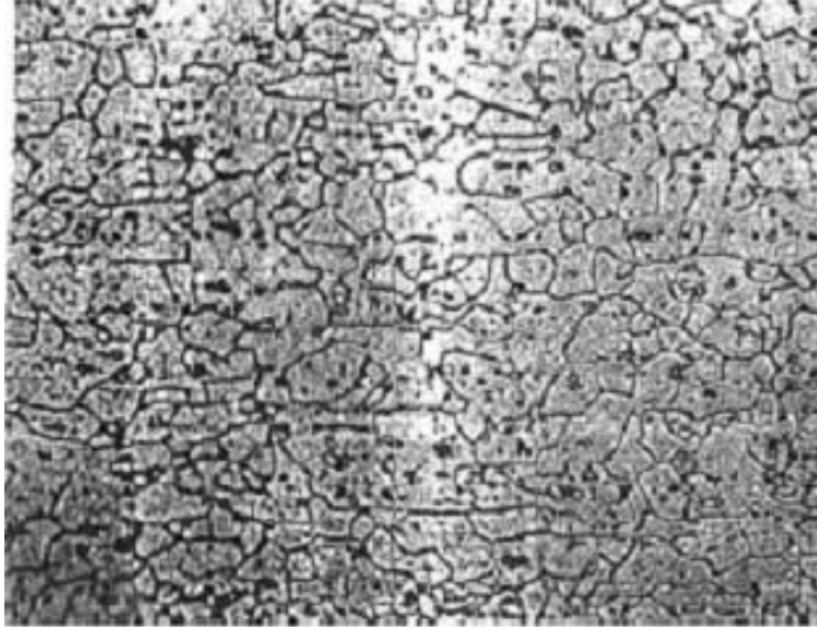
Şekil 2.6 446 tipi ferritik paslanmaz çeliğin 802°C'de tavlandıktan sonra HCl+Metanol ile dağlanmış mikro yapısı. Yapı eştaneli ferrit matriste dağılmış karbür parçacıklarından oluşmuştur [4].
