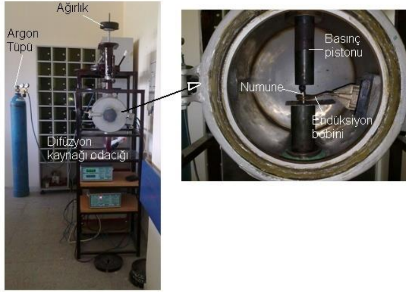
Şekil 3. 2 Difüzyon kaynak düzeneğinin şematik görüntüsü.
