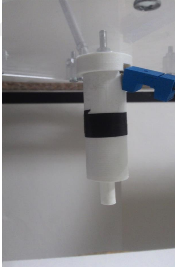
Şekil 6.39. Kuvvet algılama mekanizmasının robotun tutucu ucuna montajlı son hali
