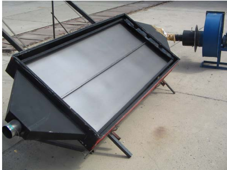
Şekil 4.2 Deney setinin yüzeysiz ana kasası
