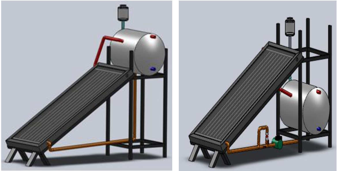
Şekil 2.17. Tasarımı yapılan doğal taşınımli ve cebri taşınımli sistemler
