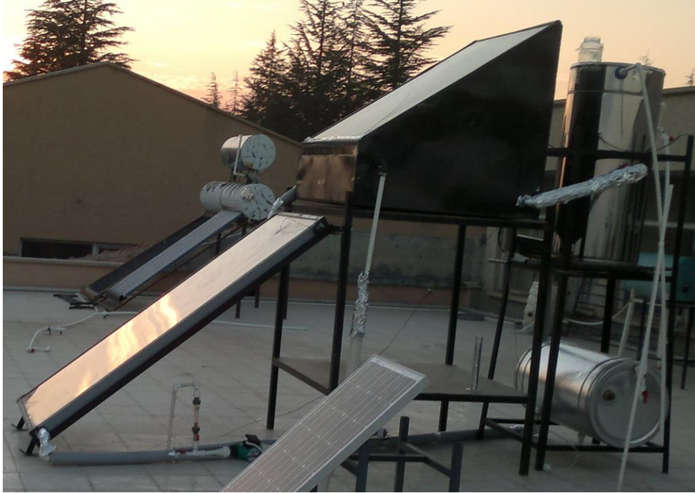
Şekil 2.1. Sıcak su kollektörü ile birleştirilmiş damıtma sistemi
