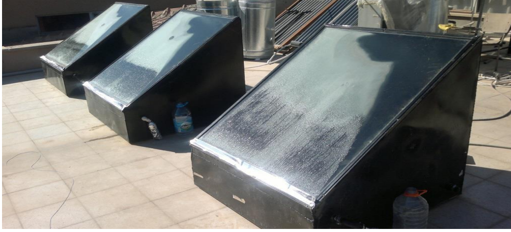
Şekil 2.19. Havuz tipi damıtıcıdaki su seviyesinin verim üzerindeki etkisi deneyleri
