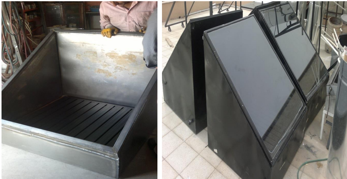
Şekil 2.8. Isı değıştirgeçlerinin havuz tipi damıtıcı içerisine yerleşirilişı
