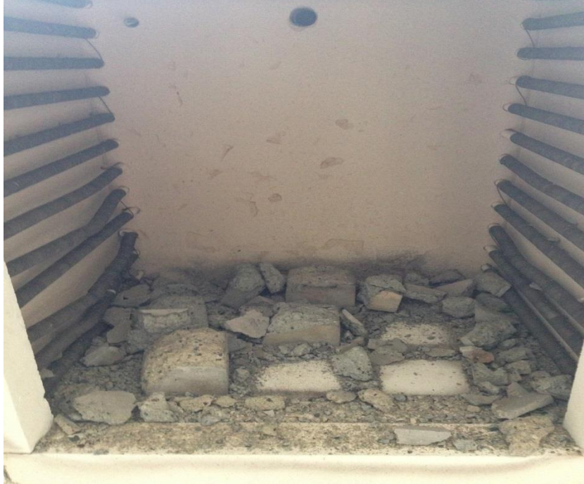
Şekil 7.1. Beton numunelerin 1000 °C’deki görüntüsü
