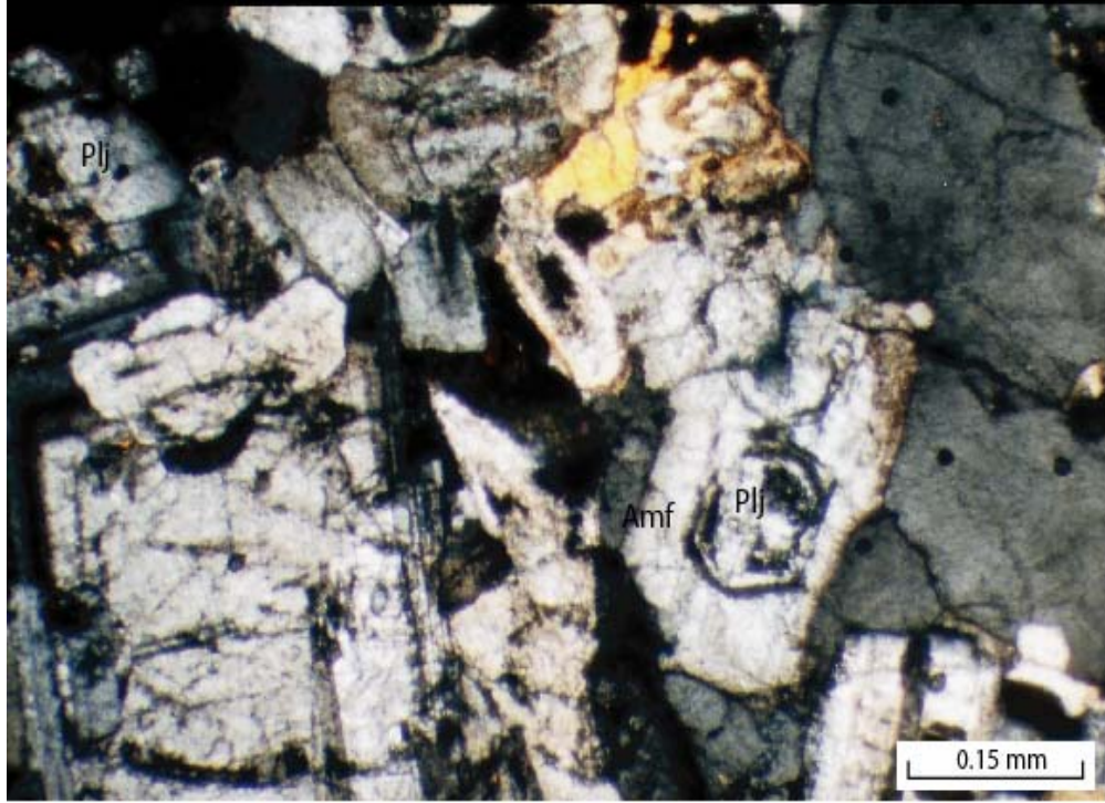
Şekil 24: Tonalit örneği. Amf: Amfibol. Plj: Plajiyoklas. 3.2 X / 0.06. Ç.N.
