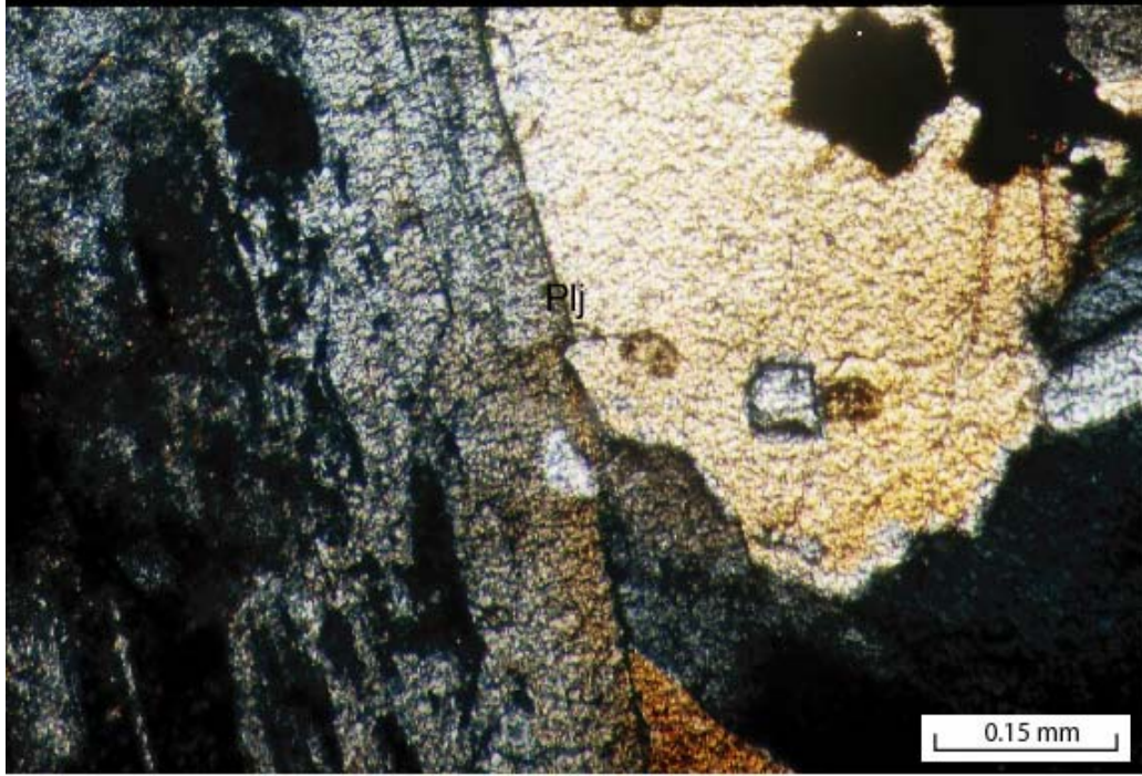
Şekil 12: Granit kayacı içerisinde zonlu yapı gösteren plajiyoklas. 10 X / 0.20. Ç.N.
