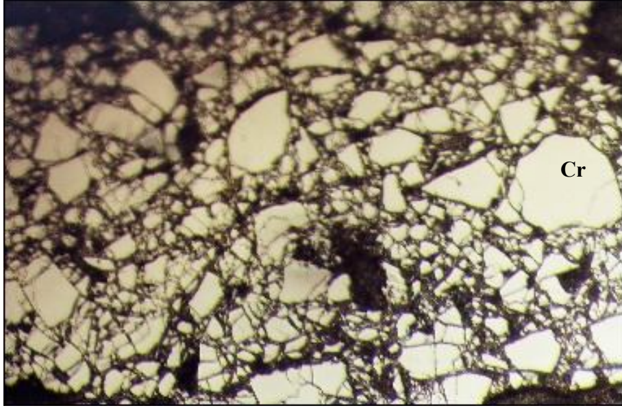
Şekil 5.8. Deformasyon sonucunda parçalanmış kromit tanelerinin mikroskopta görünümü. Cr: Kromit, T.N.X100
