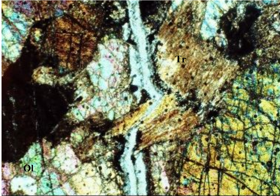
Şekil 4.8. Guleman Grubu'na ait kayalarda iğnemsî ve ışınsal tremolitlerin mikroskopta görünümü. Tr: Tremolit, Ol: Olivin, Ç.N.X32
