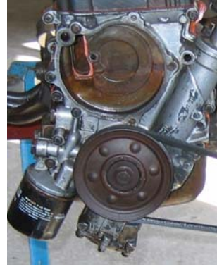
Şekil 5.4. (a) Yağ emiş tertibatı (b) Yağ pompası ve yağlama sistemi dış görünümü
