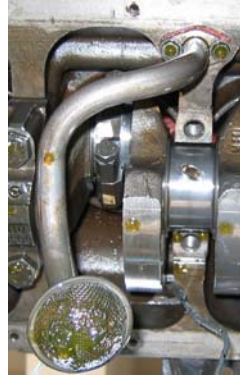
Şekil 5.4. (a) Yağ emiş tertibatı (b) Yağ pompası ve yağlama sistemi dış görünümü
