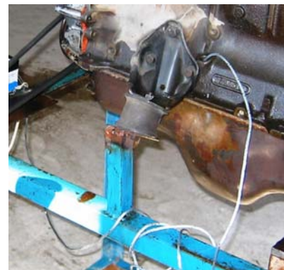
Şekil 5.5. Dijital Sıcaklık Göstergesi Ve Termo Elemanın Deney Düzeneği Üzerindeki Görünümü
