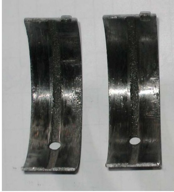
Şekil 5.9.B. Toz püskürtme yöntemiyle üretilen yatak numunesi
