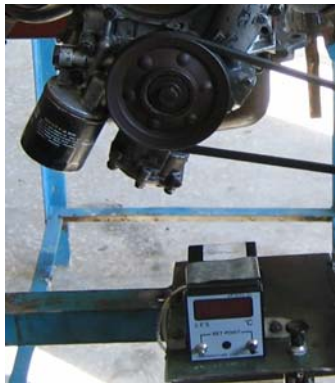
Şekil 5.5. Dijital Sıcaklık Göstergesi Ve Termo Elemanın Deney Düzeneği Üzerindeki Görünümü
