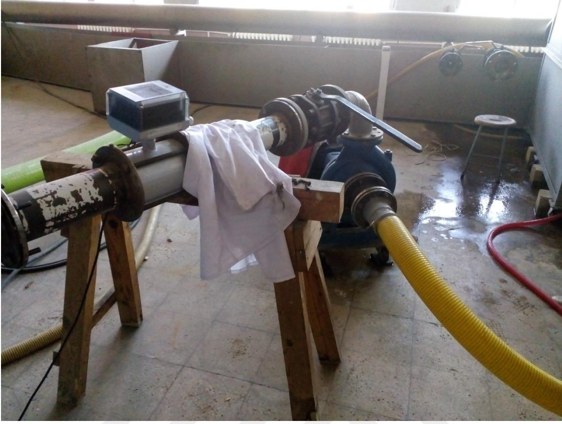
c) Deneylerde kullanılan akım kontrol vanası ve dijital göstergeli debimetre
