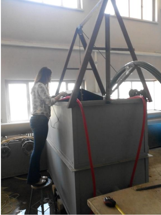
d) Hava kapanı üzerindeki hava bacasından anemometre ile emilen hava miktarının ölçümü
