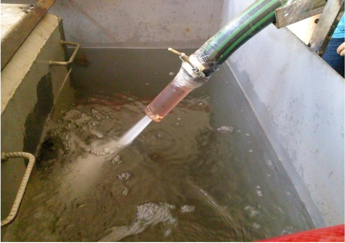
e) Su jetinin su tankına 10 cm'lik mesafeden arpması grnm
