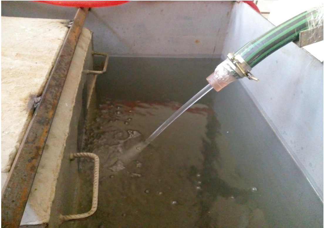
f) Su jetinin su tankına 20 cm'lik mesafeden arpması grnm
