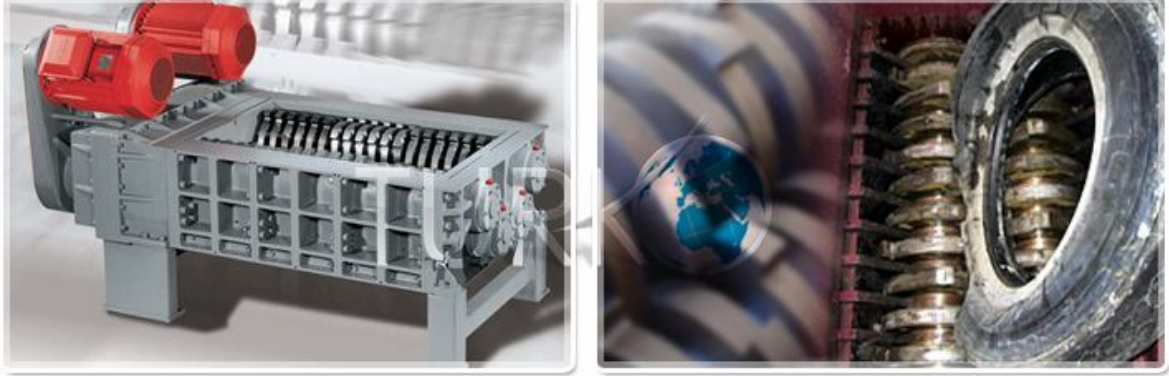
Şekil 4.8. Lastiğin mekanik olarak parçalanması [41].
