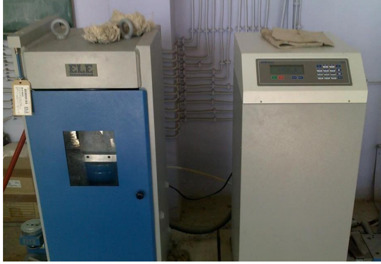
Şekil 4.9 Basınç dayanımı deney sistemi
