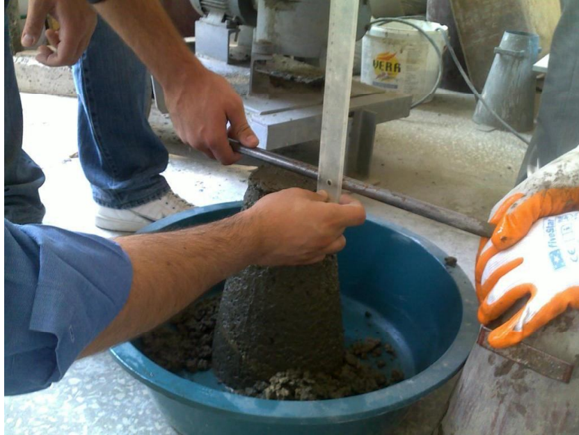
Şekil 4.8 Çökme deneyinin yapılışı
