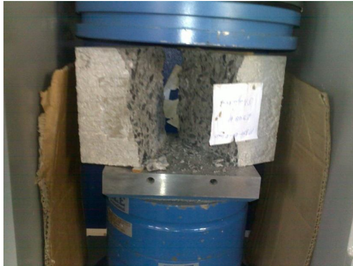
Şekil 4.10 Yarma dayanımı deney sistemi
