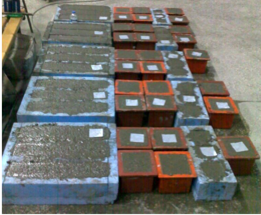
Şekil 4.6 Dökülmüş beton numuneler
