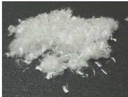
Şekil 4.2 A tipi polipropilen lif
