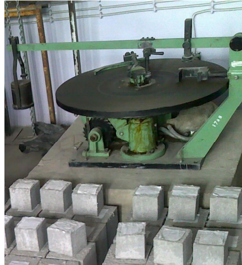
Şekil 4.13 Böhme aşınma deney düzeneği ve numuneler
