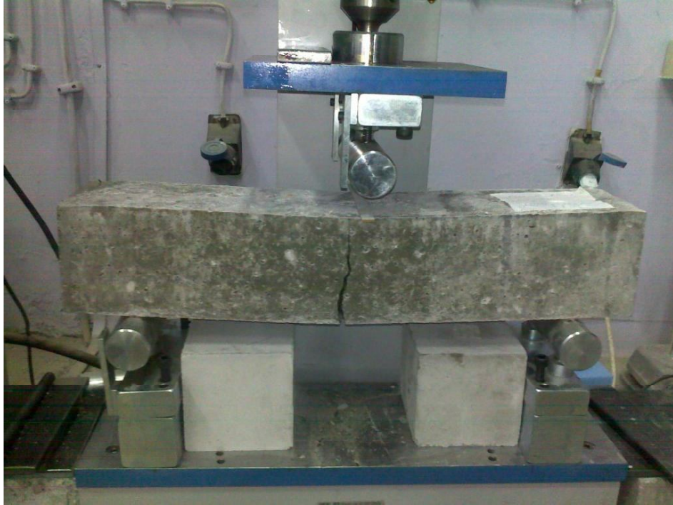
Şekil 4.11 Eğilme-çekme dayanımı deney sistemi
