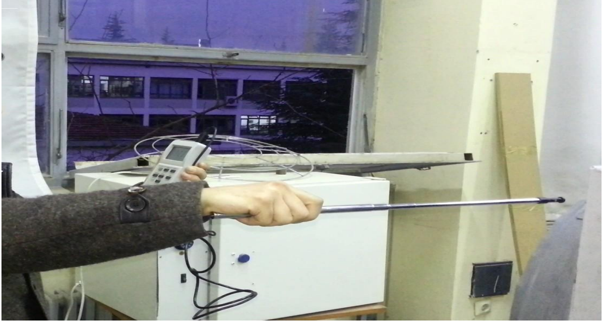
Şekil 9. Deneylerde dijital anemometre ile yapılan hız ölçümü.
