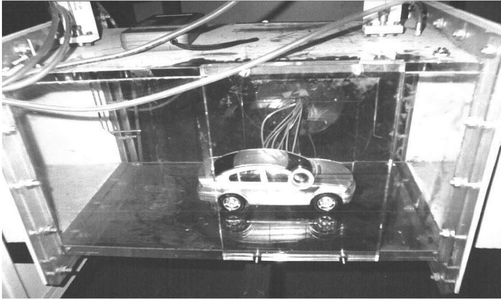
Şekil 5. Deneylerde kullanılan model aracın fotoğrafı [10].
