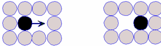
Şekil 3.3. Boşluk veya yeralan atom difüzyonu.
