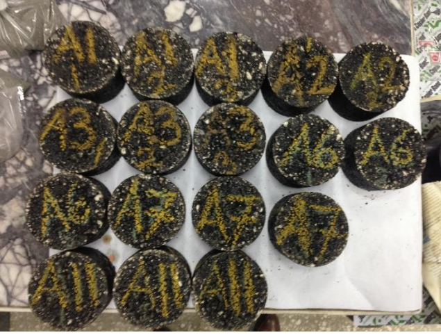
Şekil 5.4. Yoğurmalı presle sıkıştırılan ve soğumaya bırakılan bitümlü sıcak karışım (BSK) örnekleri.
