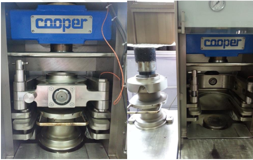
Şekil 5.3. Superpa ve yoğurmalı sıkıştırıcısı.
