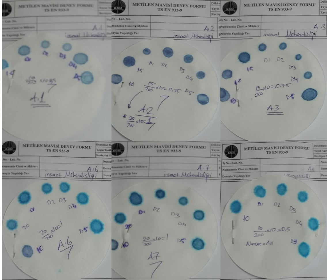
Şekil 7.1. Şartname limitlerini sağlayan örneklerin metilen mavisi deneyi sonuçları.
