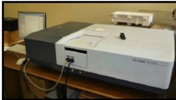
Şekil 5.4. Shimadzu UV-3600 PC marka Uv-Vis spektrometre.
