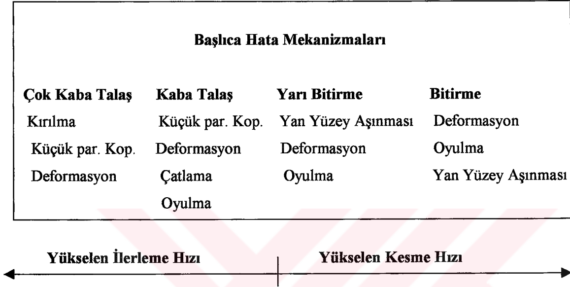
Şekil 3.1 Çeliklerin İşlenmesinde Kaplanmış Karbürlerin Başlıca Hata Mekanizmaları
