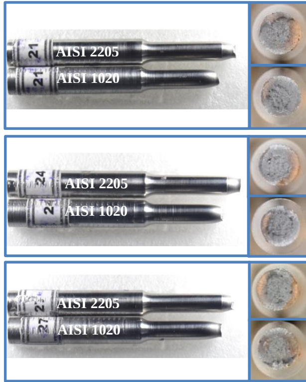
Şekil 5.64. S21, S24 ve S27 no' lu numunelere ait çekme testi sonunda elde edilen kırık yüzey makro fotoğrafları
