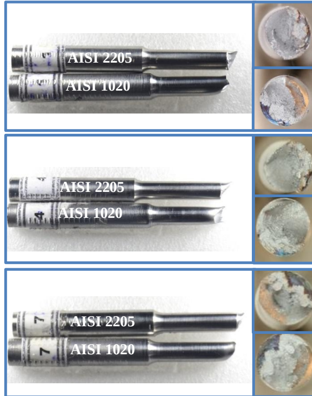
Şekil 5.46. S1, S4 ve S7 no' lu numunelere ait çekme testi sonunda elde edilen kırık yüzey makro fotoğrafları
