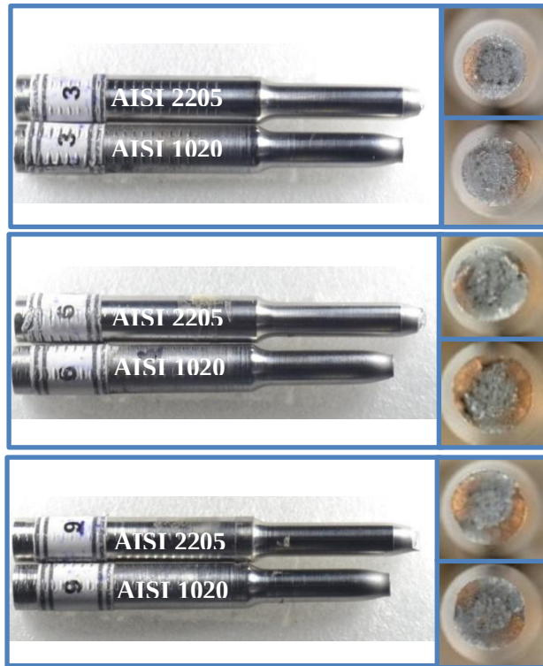
Şekil 5.51. S3, S6 ve S9 no' lu numunelere ait çekme testi sonunda elde edilen kırık yüzey makro fotoğrafları
