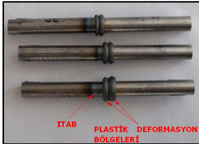
Şekil 3.13. Farklı kaynak parametrelerinin kullanılması ile ITAB' da oluşan değişiklikler
