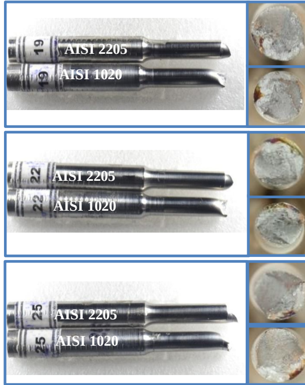
Şekil 5.60. S19, S22 ve S25 no' lu numunelere ait çekme testi sonunda elde edilen kırık yüzey makro fotoğrafları
