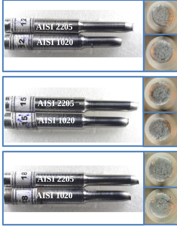
Şekil 5.58. S12, S15 ve S18 no' lu numunelere ait çekme testi sonunda elde edilen kırık yüzey makro fotoğrafları
