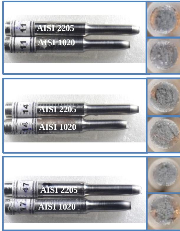
Şekil 5.55. S11, S14 ve S17 no' lu numunelere ait çekme testi sonunda elde edilen kırık yüzey makro fotoğrafları
