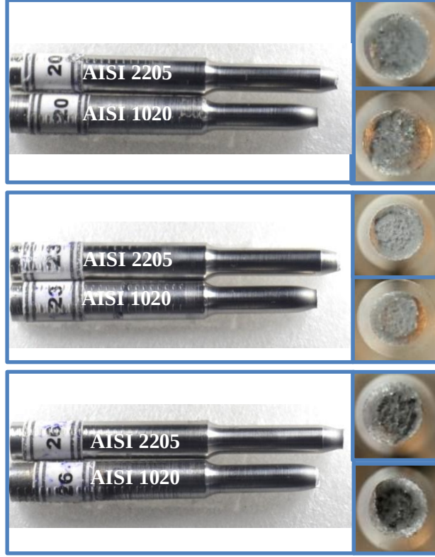
Şekil 5.62. S20, S23 ve S26 no' lu numunelere ait çekme testi sonunda elde edilen kırık yüzey makro fotoğrafları
