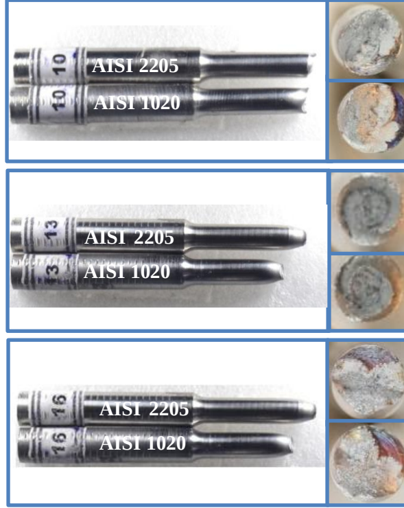
Şekil 5.53. S10, S13 ve S16 no' lu numunelere ait çekme testi sonunda elde edilen kırık yüzey makro fotoğrafları
