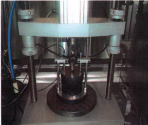
Şekil 4.9. Numunenin SYSS Deney Aletine Yerleştirilmesi
