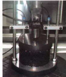
Şekil 4.9. Numunenin SYSS Deney Aletine Yerleştirilmesi
