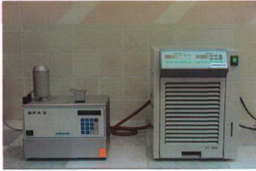
Şekil 3.7. Fraas Deney Aleti ve Soğutucu
