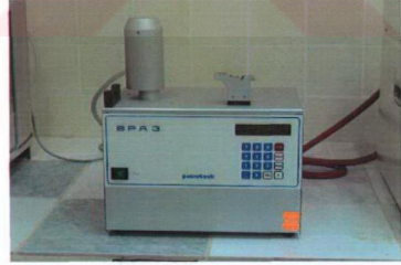
Şekil 3.7. Fraas Deney Aleti ve Soğutucu
