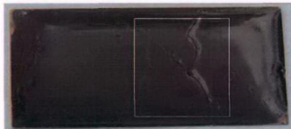
Şekil 3.8. Numunelerde Meydana Gelen Çatlaklar
