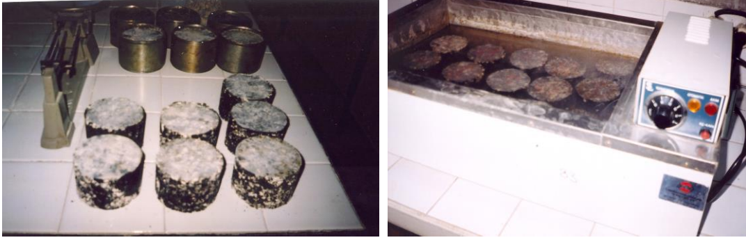
Şekil 6.15. Marshall numuneleri ve kürü
