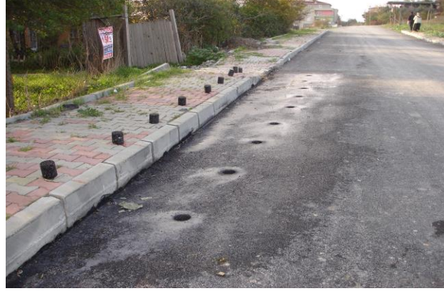
Şekil 7.35. Yol kenar güzergahı boyunca alınan karotlar
