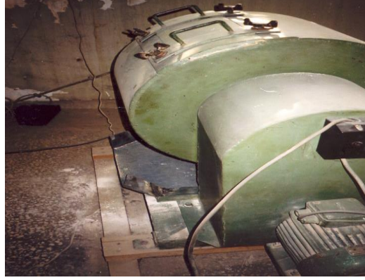
Şekil 6.7. Agreg a aşınma deneyi test cihazı
