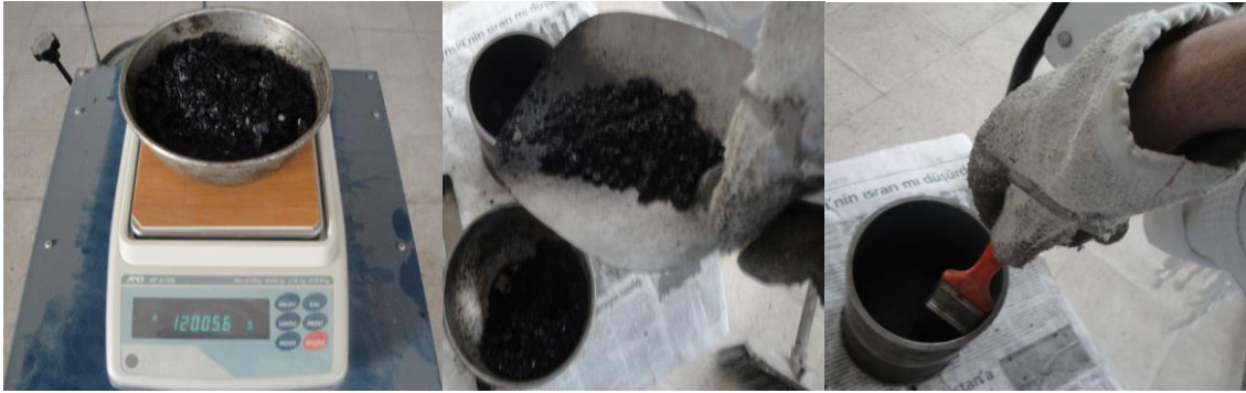
řekil 6.12. BSK numune hazırlanması ve silindir kalıba yerleřtirilmesi
