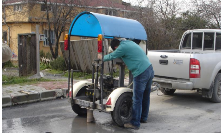
Şekil 6.34. Karot makinesi ile silindir asfalt numunesi alınması
