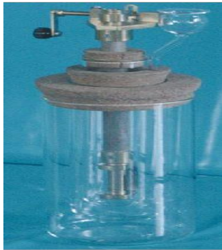
Şekil 6.4. Frass kırılma noktası aparatları
