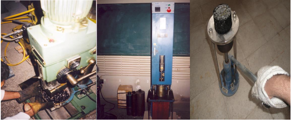
Şekil 6.13. BSK numunelerin karıştırılması, sıkıştırılması ve kalıptan çıkarılması
