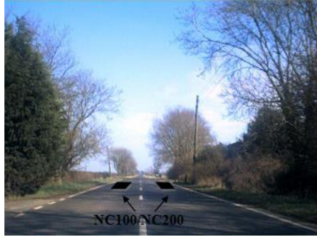
Şekil 6.29. Mobil trafik analiz cihaz kurulumu
