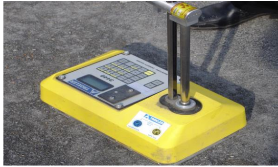
Şekil 6.35. Nükleer test cihazı ile yoğunluk ölçümü
