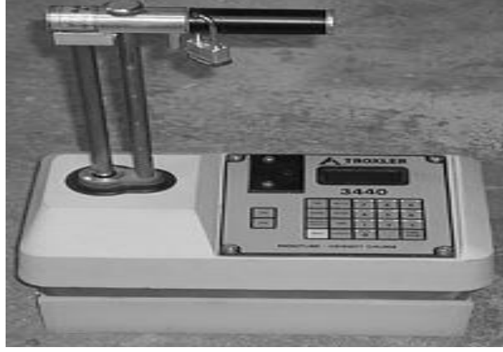
Şekil 2.11. Sıkıştırma yüzdesi tayininde kullanılan nükleer metod deney cihazı
