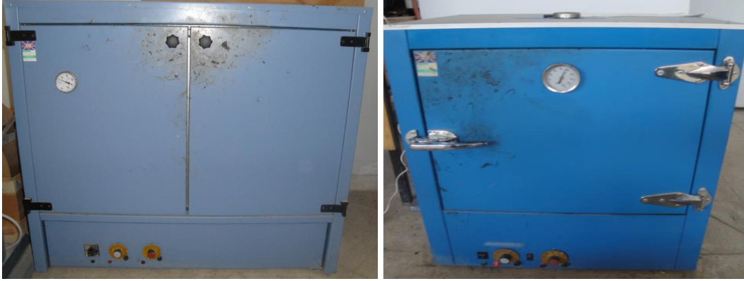
řekil 6.11. Agrega ve bitümlerin ısıtıldığı etüvler
