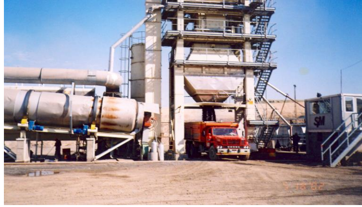
Şekil 2.6. Bitümlü asfalt karışımların elde edildiği harman tipi plant
