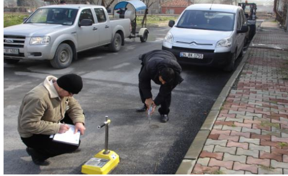
řekil 6.36. Schmitd çekiciyle yüzey sertlięi ölçümü
