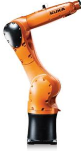
Şekil 1. 1 Robot kol örneği ( KR6 - R900)
