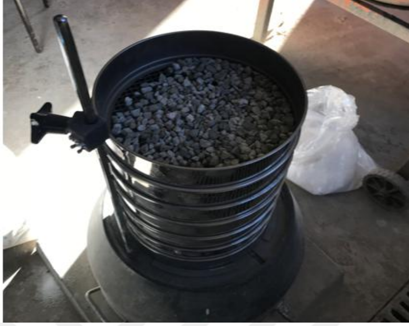
Şekil 3.8. Agregaların elek analizine tabi tutulması
