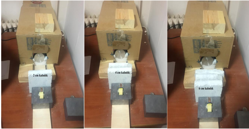
Şekil 3.23 NaI (TI) detektörlü gama spektroskopi ölçüm sistemi
