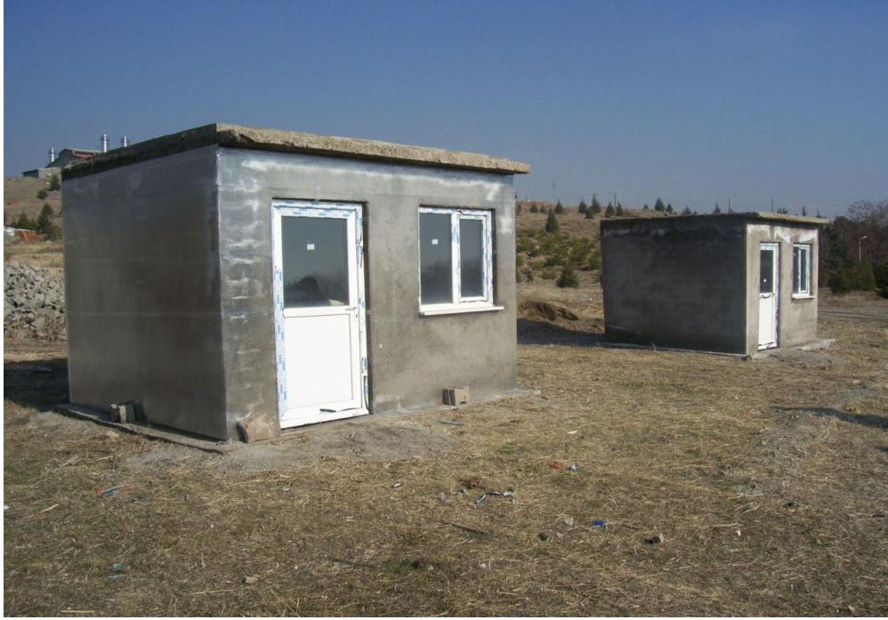
Şekil 2.1. Deneyler için inşa edilen test odaları (soldaki duvarları FDM ile ısı yalıtımlı odadır)
