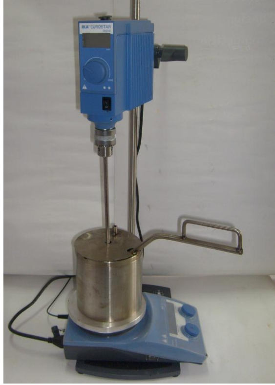
Şekil 7.3. Modifiye Bitüm Karıştırma Cihazı.
