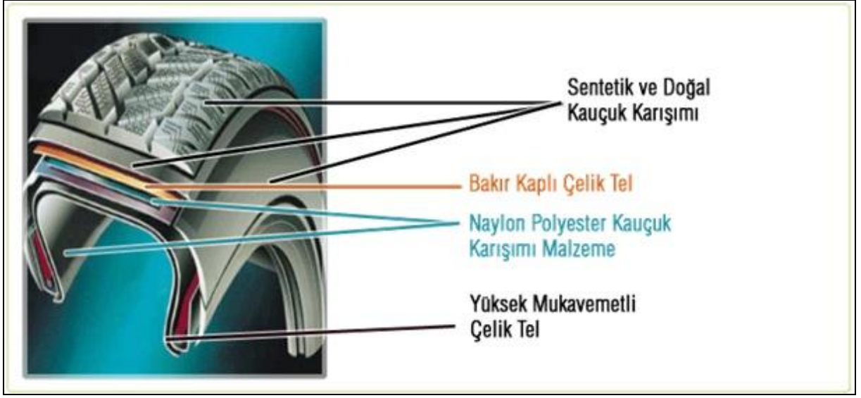
Şekil 5.1. Araç Lastiklerinin Yapısı [URL-5].
