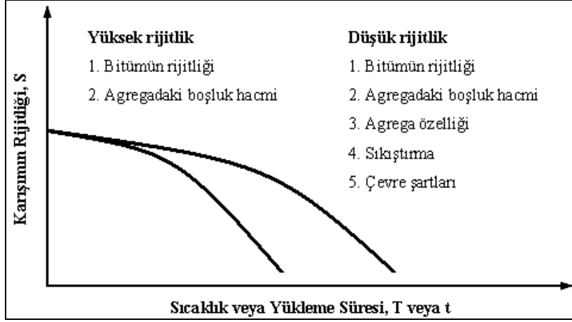
Şekil 3.2. Sıcaklık veya Yükleme Süresinin bir Fonksiyonu Olarak Karışım Rijitliği [Shell Bitüm El Kitabı, 2004].
