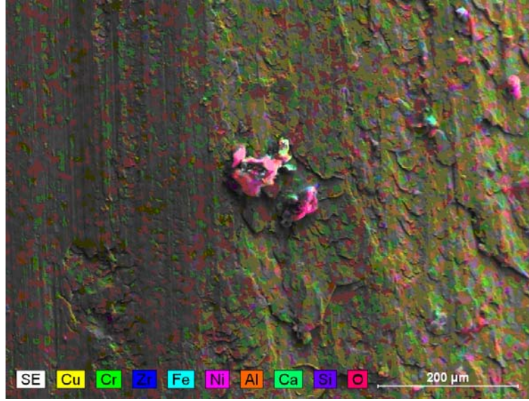
Şekil 8.22 (a) A14 numunesinin yüzeyinden alınan SEM fotoğrafı (10 A, +/-, 4,2 m/s).
