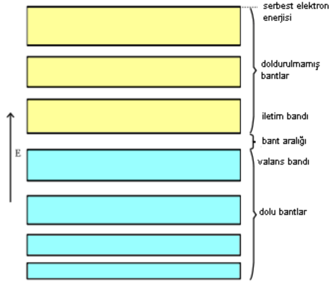
Şekil 2.1. Yarıiletkenlerin band yapısı
