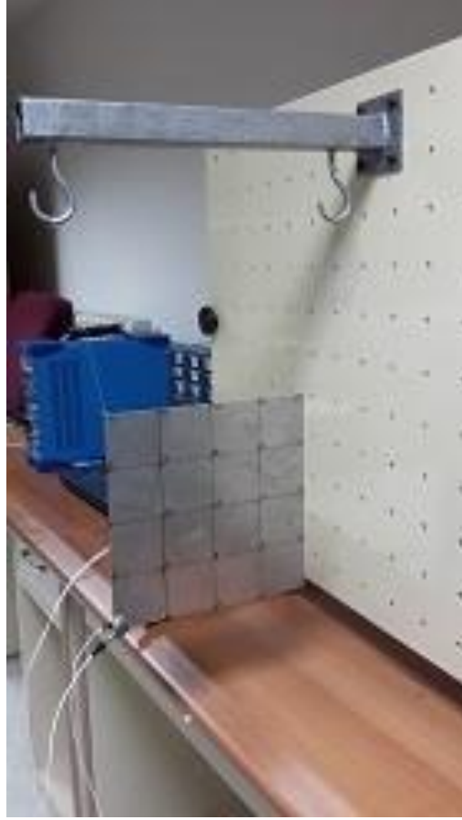
Şekil-6. 5. Modal analiz için hazırlanmış deney numunesi
