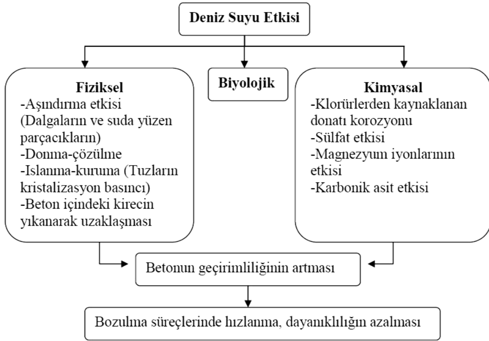
Şekil 4.2. Deniz ortamında bulunan yapıların maruz kalacağı yıpratıcı etkiler [37].
