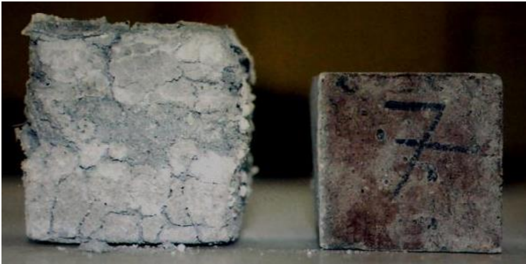
Şekil 3.2. Yüksek oranda alçıtaşı (kalsiyum sülfat) içeren harç örneklerinin havada ve su içinde bekletilmeleri halinde 84 gün sonundaki durumları. Soldaki ağır hasarlı örnek su içinde, sağdaki örnek ise havada bekletilmiştir
