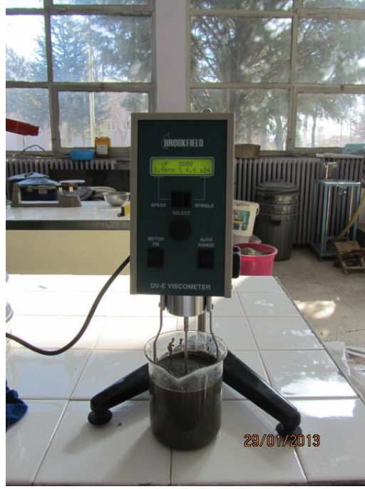
Şekil 5.7. Brookfield DV-E model viskozimetre aleti
