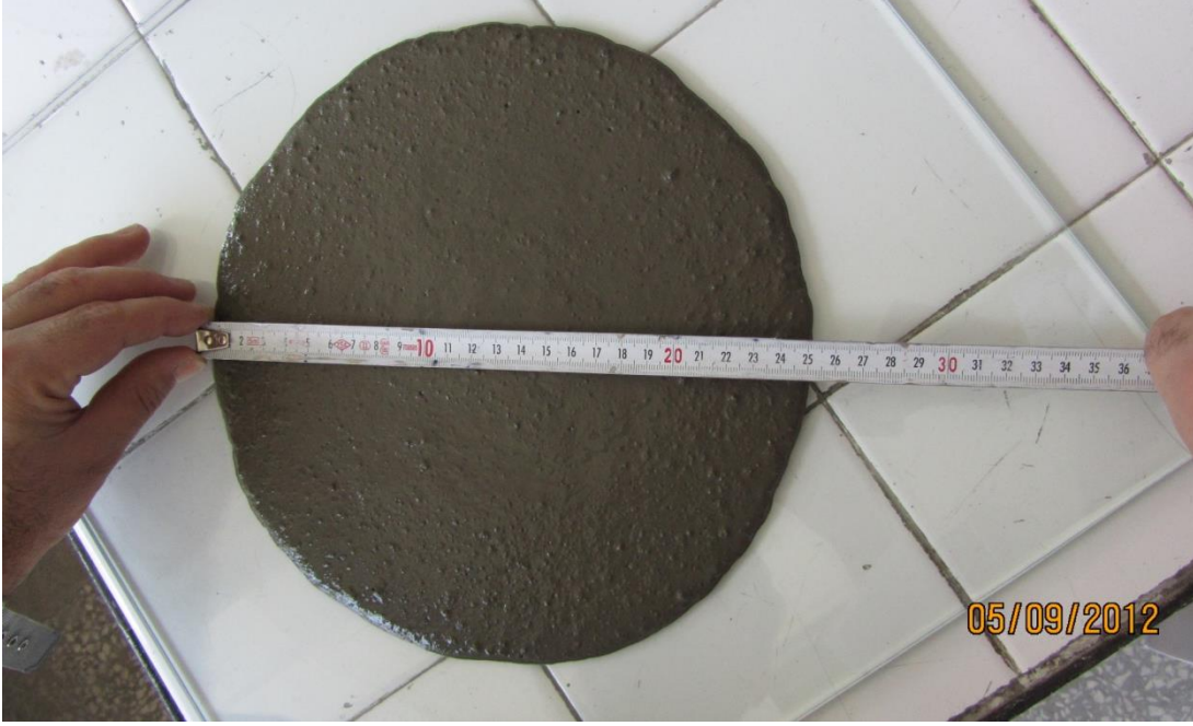
Şekil 5.5. Mini çökme-yayılma deneyi
