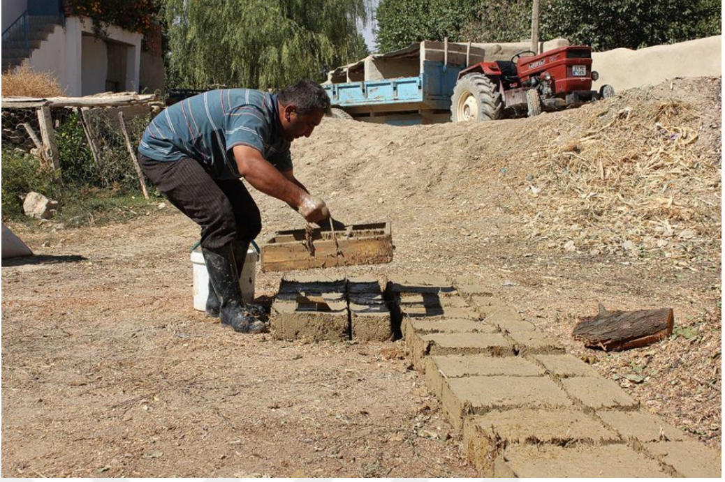
Foto 56 - Kerpicin Kalıp Haline Getirilme İşlemi
