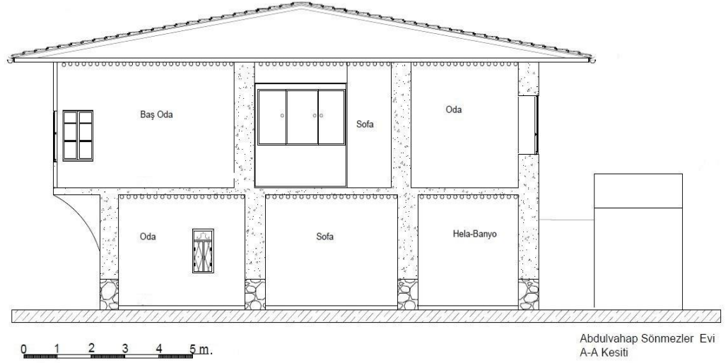
Çizim 8. Abdulvahap Sönmezler Evi A-A Kesiti
