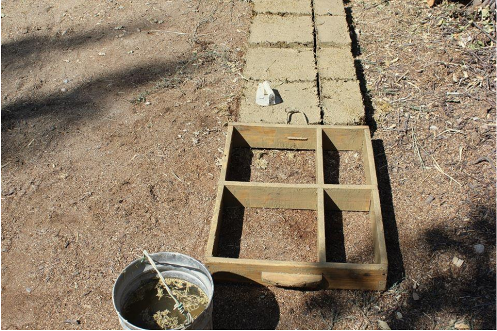
Foto 57 - Kerpicin Kalıp Haline Getirilme İşlemi
