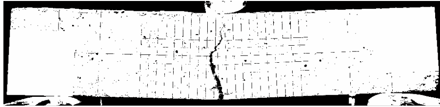
Şekil 3.27 Eşikleme İşlemi uygulanan 50. resmin görünümü
