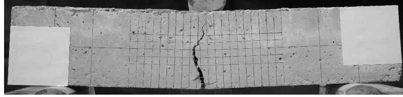
Şekil 3.26 Gri seviyeye dönüştürülen 50. resmin görünümü
